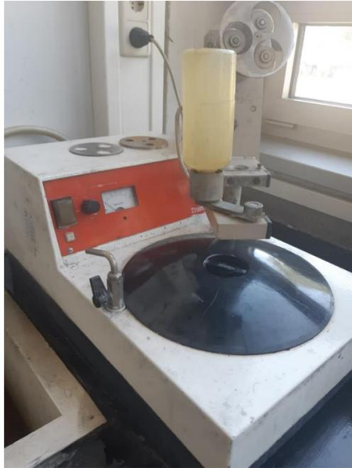
*Slika 19. Uređaj za poliranje*
