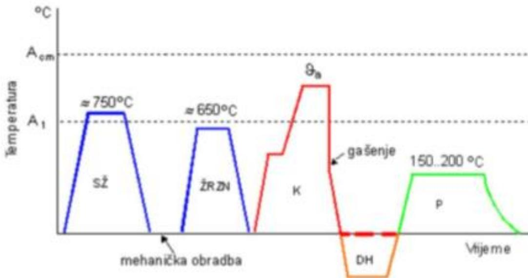
Slika 8: Toplinska obrada čelika EN 100Cr6 [11]
