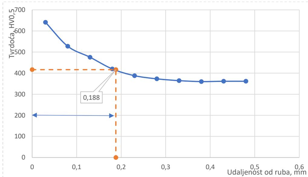
Slika 42. . Efektivna dubina nitriranja prstena nitriranog u plinu
