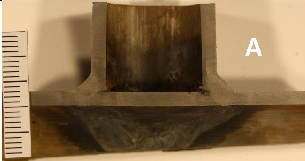
Slika 18. Makro izbrusak presjeka zavara - uzorak A
