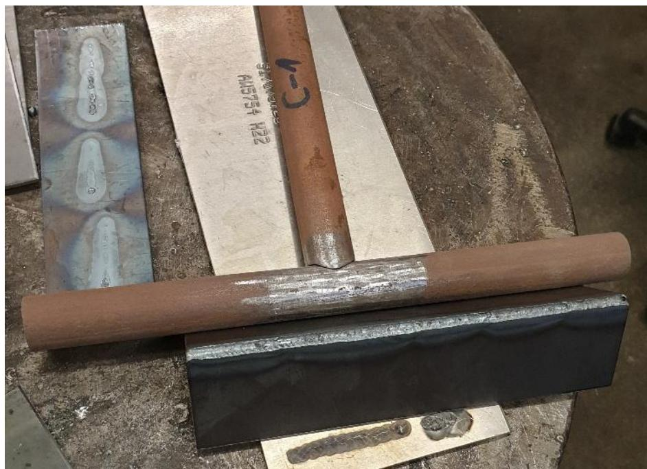
Slika 13. Pripremljene cijevi za zavarivanje kutnog spoja
