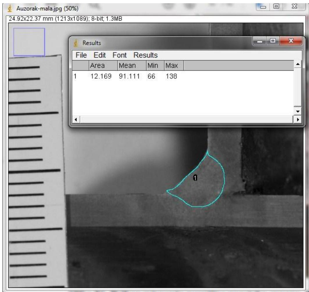
Slika 22. Prikaz mjerjenja površine zavara – A uzorak
