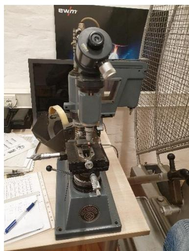
Slika 26. Uređaj za ispitivanje tvrdoće - Reichert
