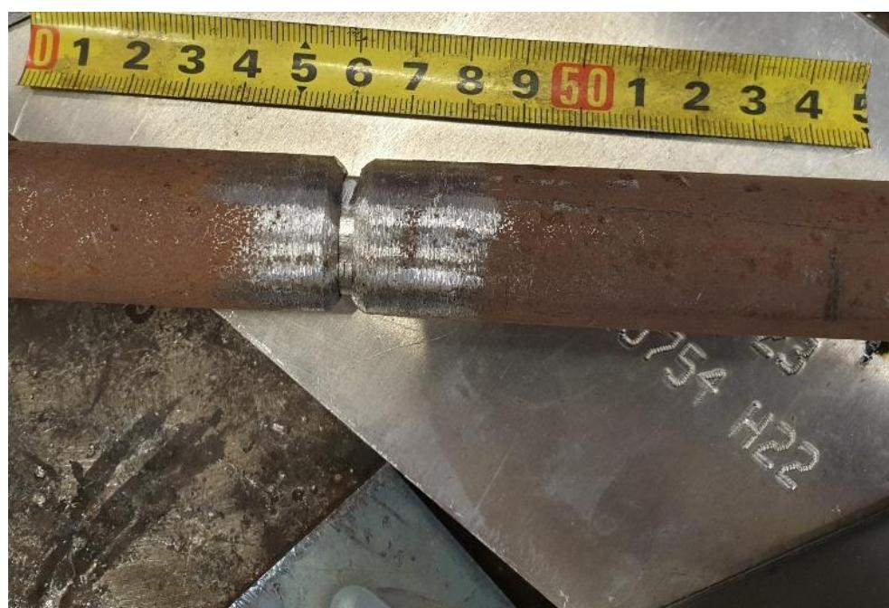
Slika 14. Pripremljene cijevi za zavarivanje čeonog spoja
