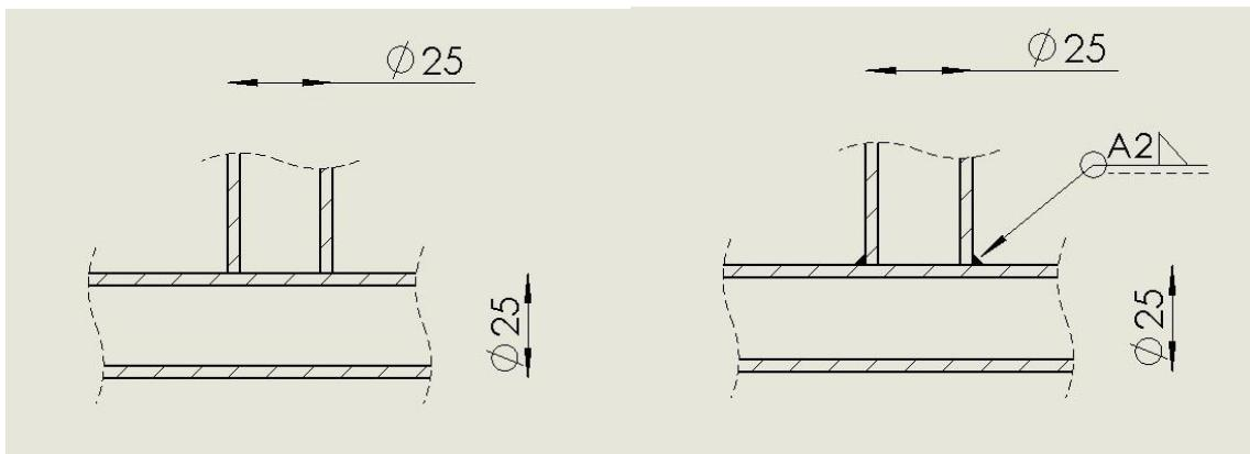
Slika 11. Priprema T zavara (lijevo), izgled zavara (desno)
