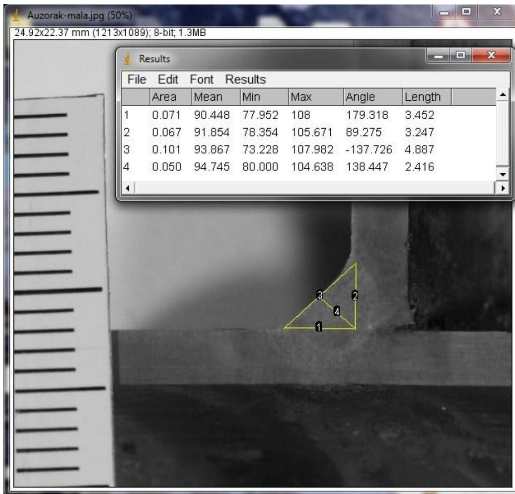
Slika 20. Prikaz mjerjenja visine zavara – A uzorak
