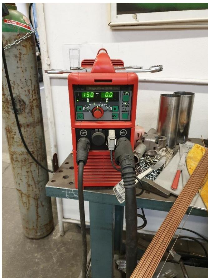
Slika 8. Izvor struje za zavarivanje MagicWave 2200
