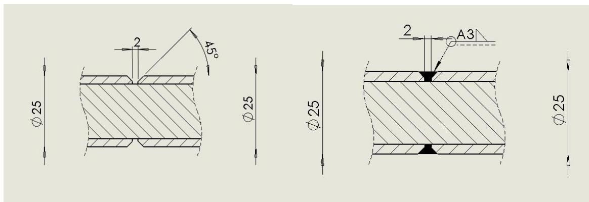
Slika 10. Priprema čeonog zavara (lijevo), izgled zavara (desno)
