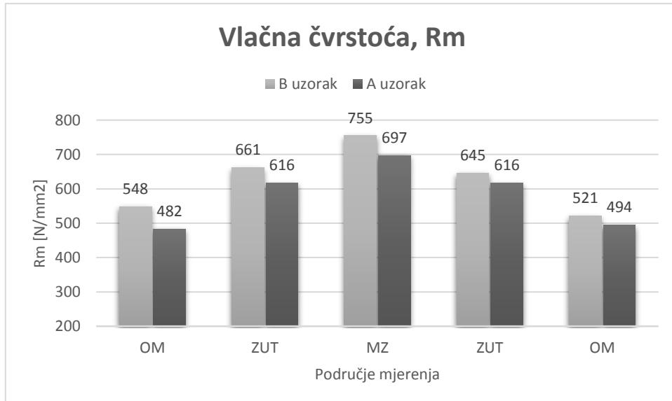
**Slika 30.** Vrijednosti dobivene vlačne čvrstoće [ $R_m$ ]
