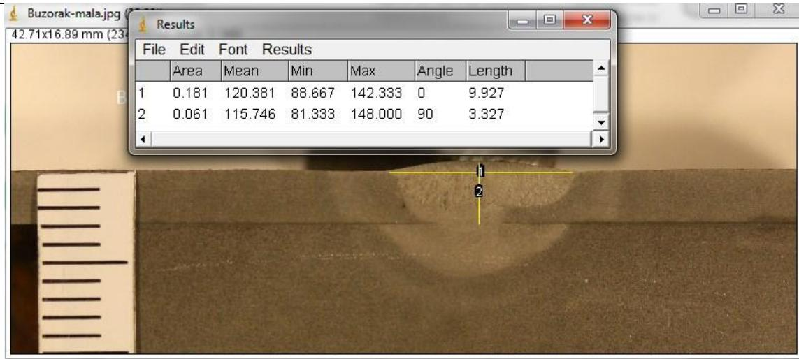
Slika 21. Prikaz mjerjenja visine zavara – B uzorak
