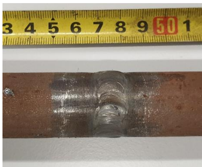
Slika 16. Zavareni sučioni spoj
