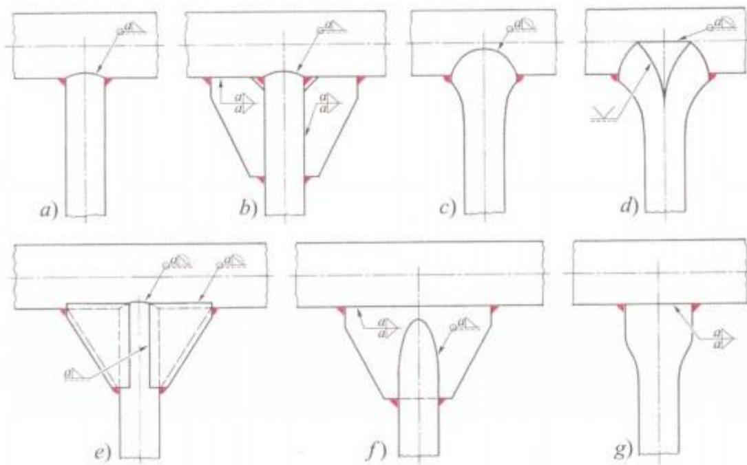
**Slika 3. Zavareni cijevni priključci:** a) bez ukrućenja; b) s kutnim rebrima; c) s proširenim krajevima cijevi; d) s prerezanim krajevima cijevi i uloženim limovima; e) sa sedlastim limovima; f) sa zarubljenim i prorezanim krajevima cijevi; g) s plosnato stisnutim krajevima cijevi [6]
