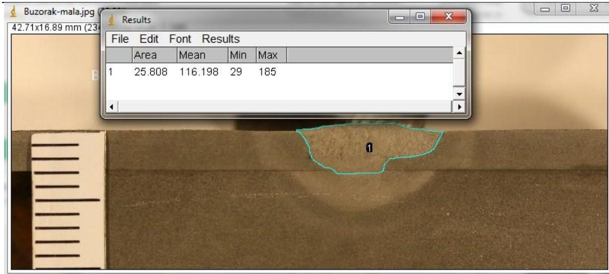
Slika 23. Prikaz mjerjenja površine zavara – B uzorak
