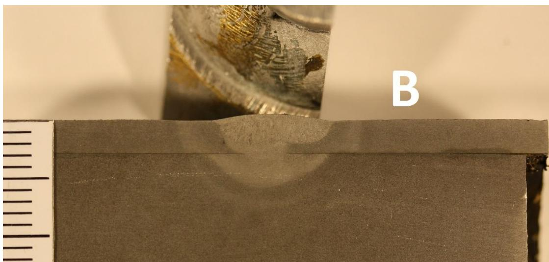
Slika 19. Makro izbrusak presjeka zavara - uzorak B
