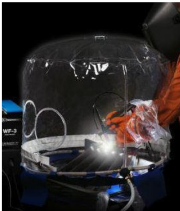
Slika 11. Izvođenje postupka zavarivanja u komori za zavarivanje [12]
