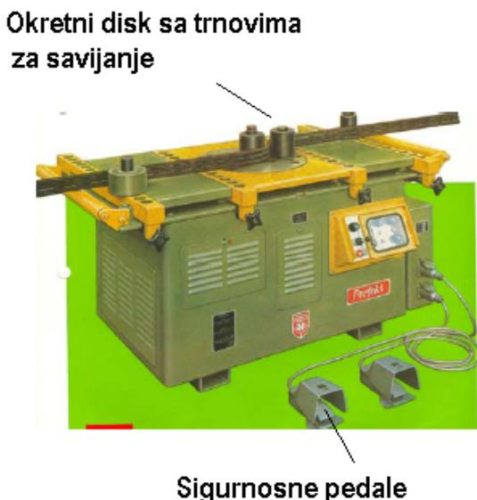
Slika 3.2 Stroj za savijanje čeličnih šipki
