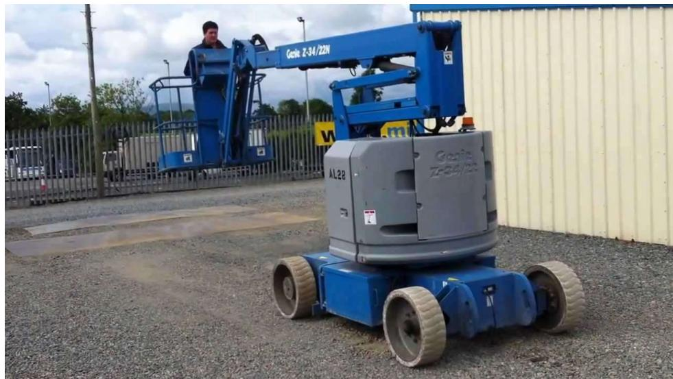
Slika 13. Genie Z34/22N pogonjen sustavom baterija
