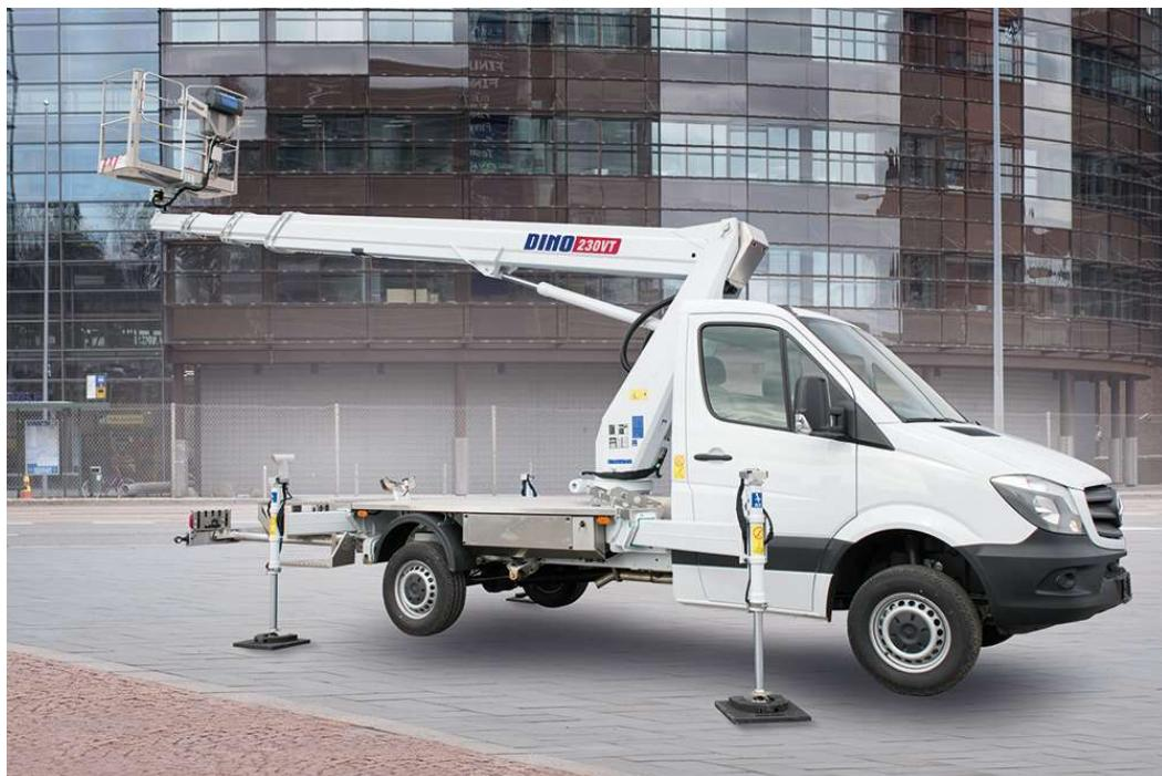
Slika 17. Osiguravanje stabilnosti pomoću stabilizatora
