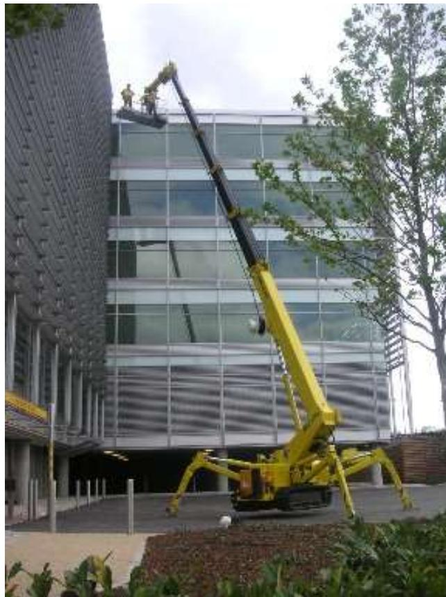
Slika 8. Primjena teleskopskog hidrauličkog cilindra
