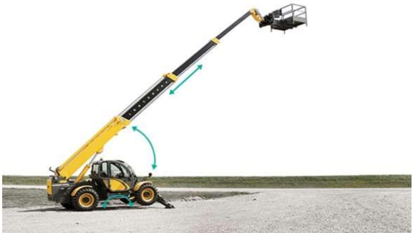
Slika 5. Radna platforma sa teleskopskim mehanizmom
