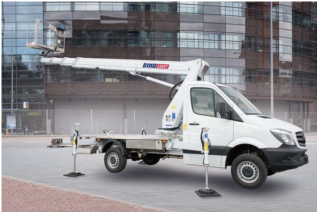
Slika 17. Osiguravanje stabilnosti pomoću stabilizatora
