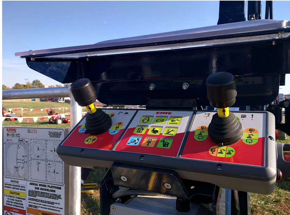
Slika 19. Upravljačka ploča na bazi uređaja
