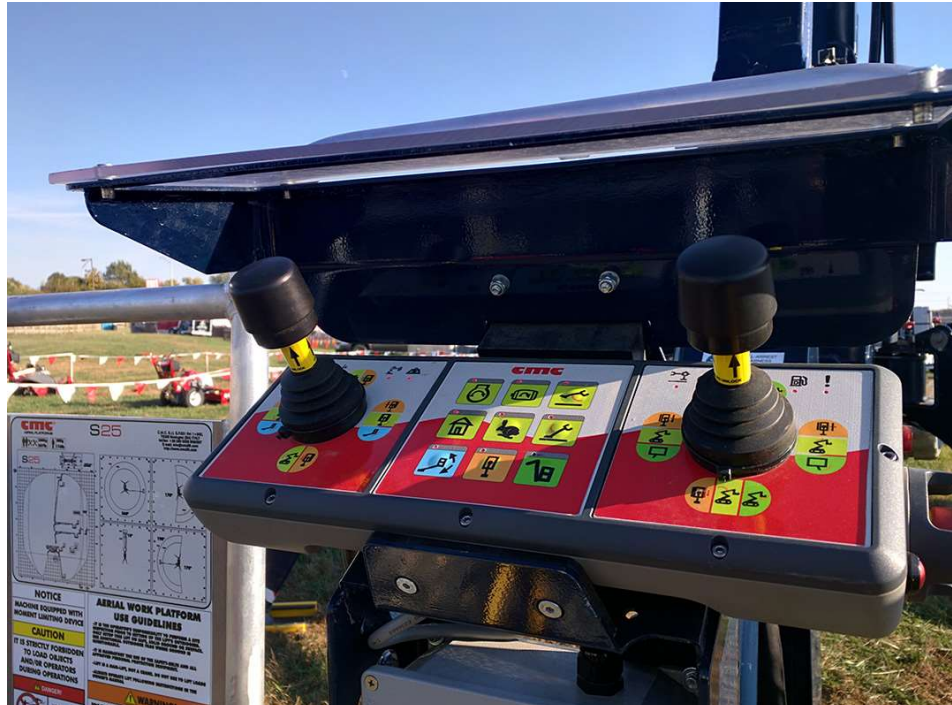
Slika 19. Upravljačka ploča na bazi uređaja
