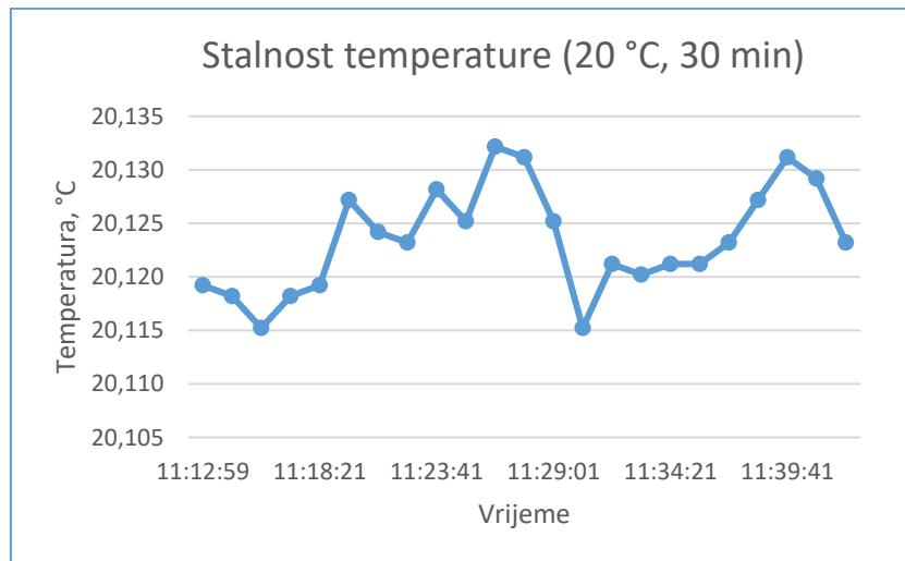
Slika 16. 30 minutna stalnost temperature pri 20 °C
