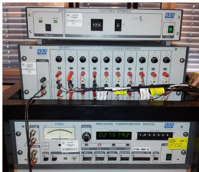
**Slika 9.** Termometrijski otpornički most sa svim spojenim komponentama
