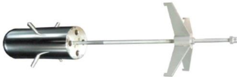
Slika 2. Izotermalni blok za termostatirane kupke
