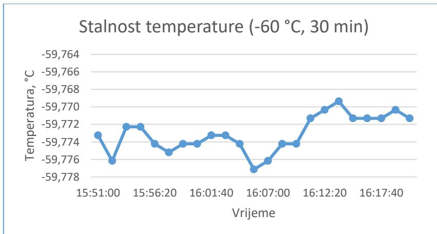
Slika 14. 30 minutna stalnost temperature pri -60 °C
