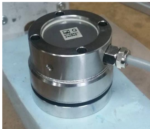
Slika 18. Vlačno-tlačni osjetnik sile HBM U3 0,5 kN
