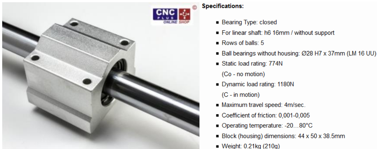
Slika 39. Linearni ležaj i specifikacije tvrtke "CNC plus"[18]
