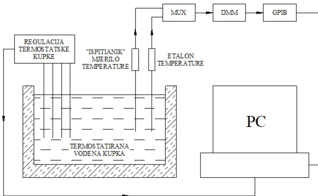
**Slika 14.** Shema spajanja mjerila temperature s mjernim elementima
