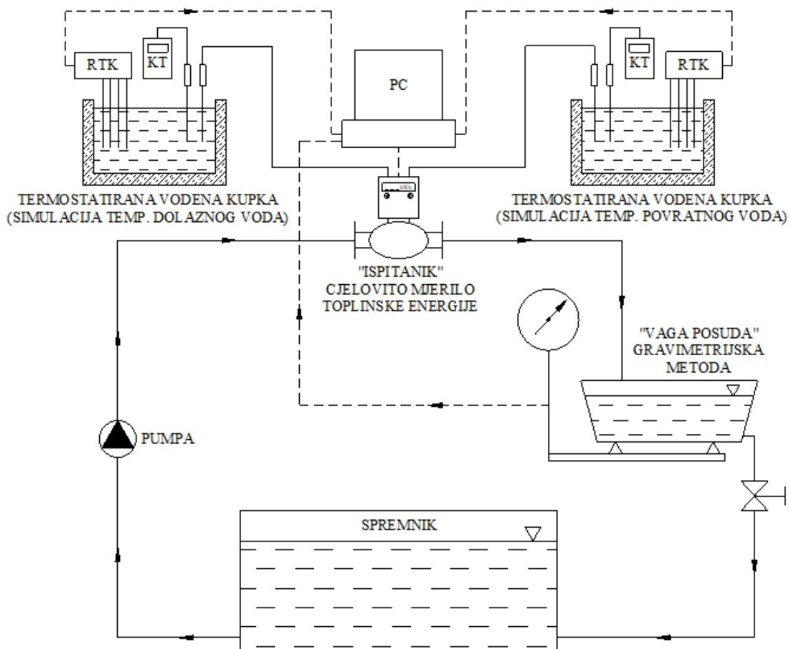
Slika 17. Shema spajanja cjelevitog mjerila s mjernim elementima
