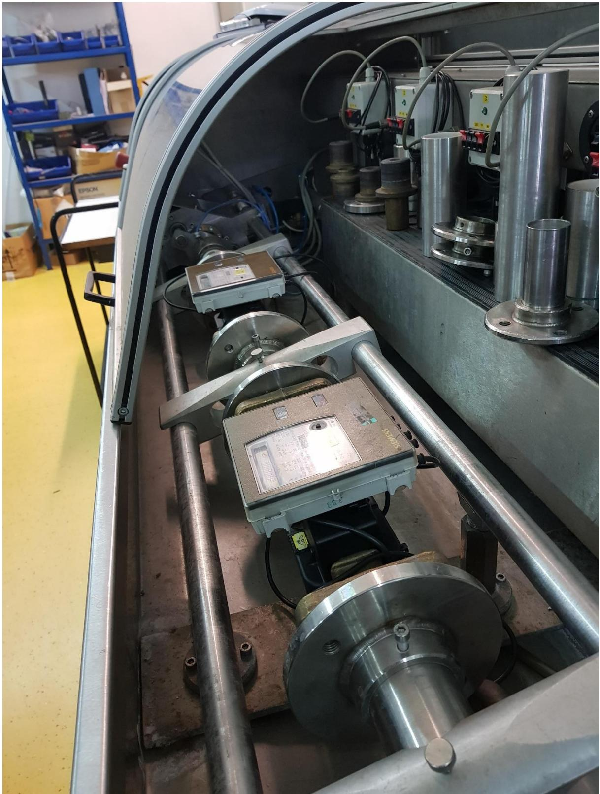
Slika 19. Mjerilo protoka spojeno na mjernu liniju
