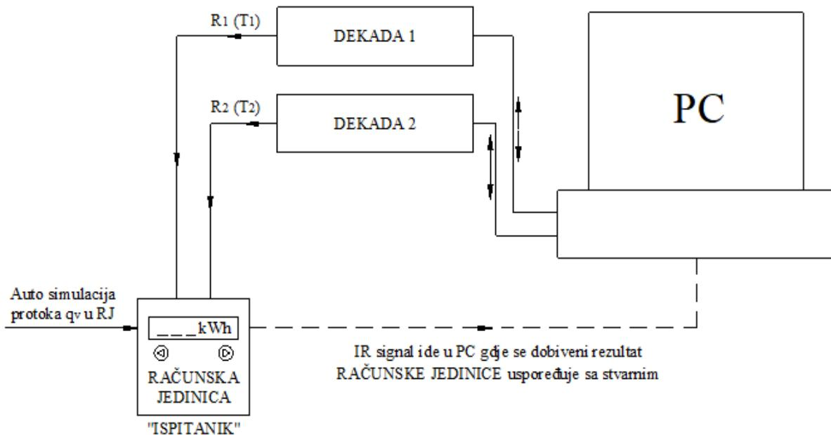
Slika 16. Shema spajanja računske jedinice s mjernim elementima
