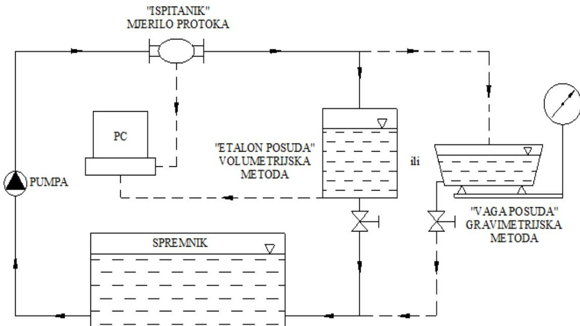
Slika 15. Shema spajanja mjerila protoka s mjernim elementima
