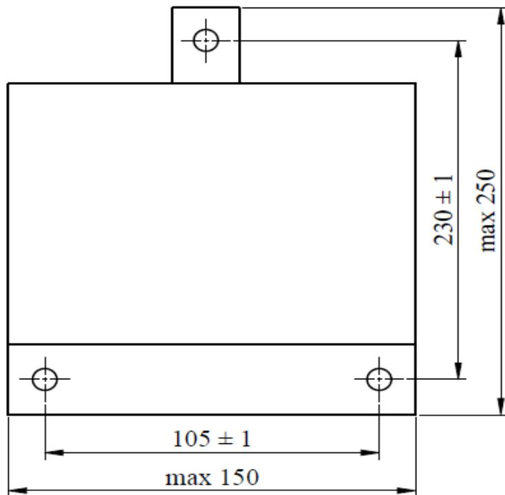
Slika 13. Mehaničke dimenzije računske jedinice prilikom ugradnje na zid
