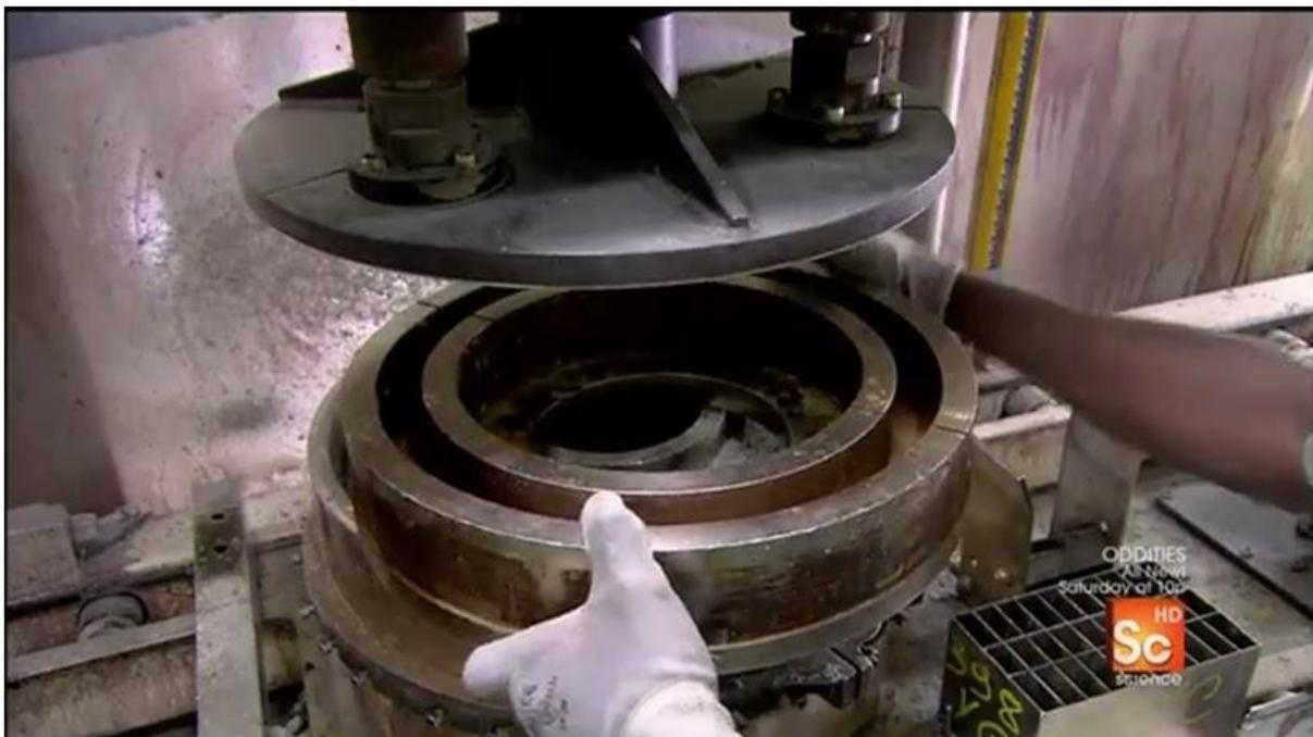
Slika 11. Izrada keramičkih diskova u kalupima [8]
