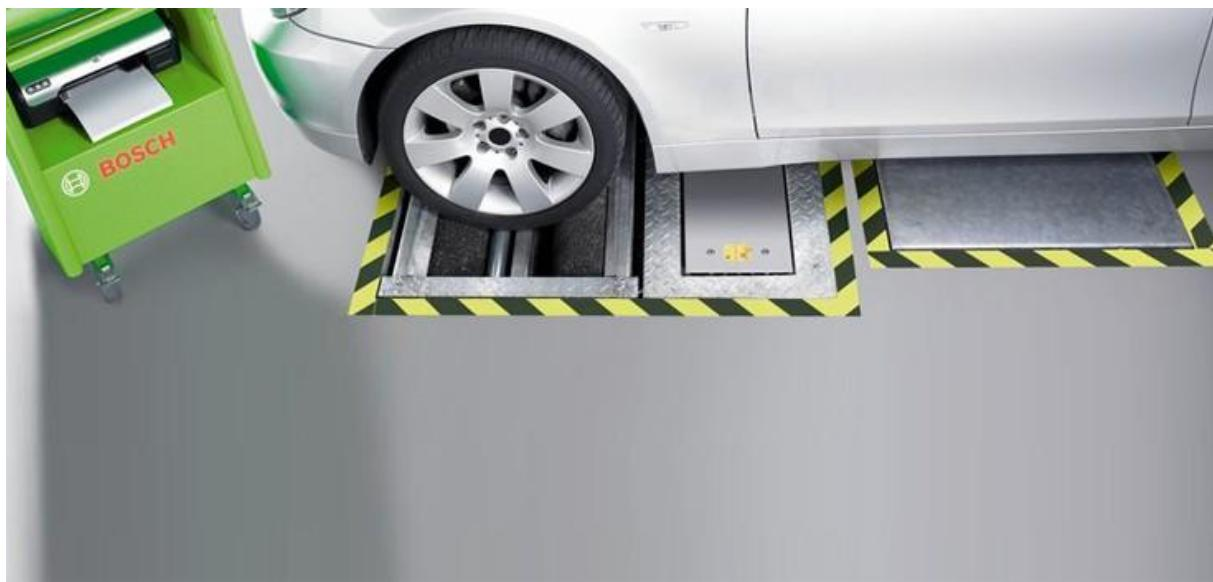
Slika 2. Ispitivanje kočnica na valjcima za tehnički pregled [4]
