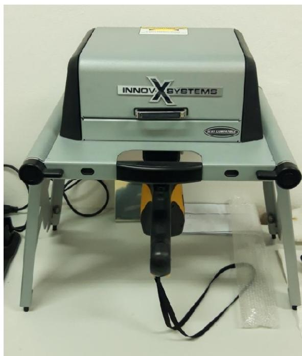
Slika 37. XRF analizator kemijskog sastava proizvođača Innov-X Systems
