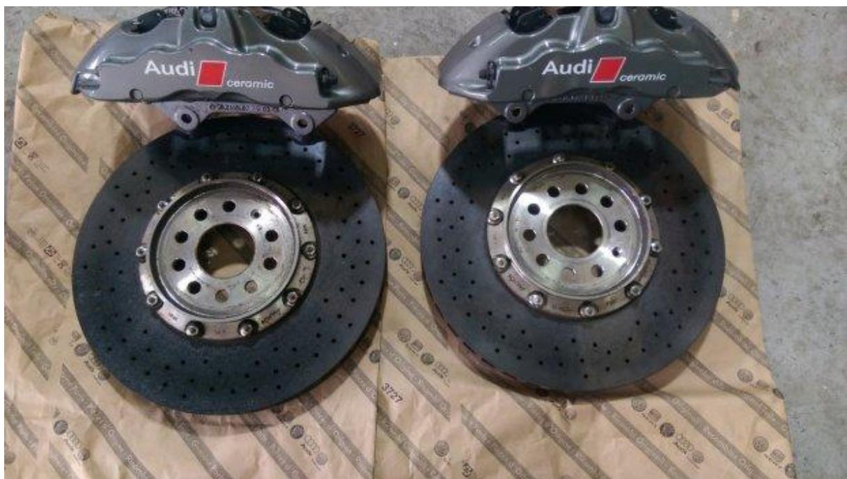
Slika 10. Keramički diskovi za Audi A8 [9]
