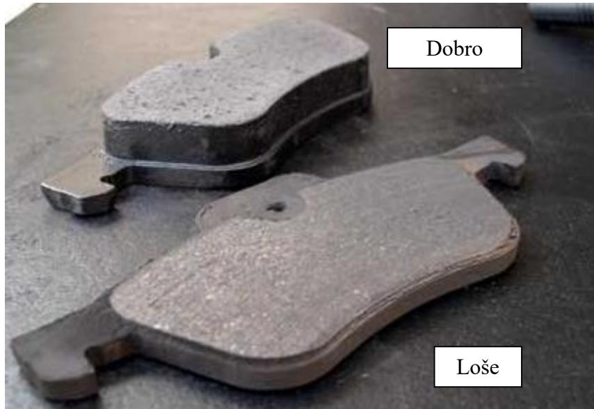
Slika 15. Primjer nove i potrošene disk pločice
