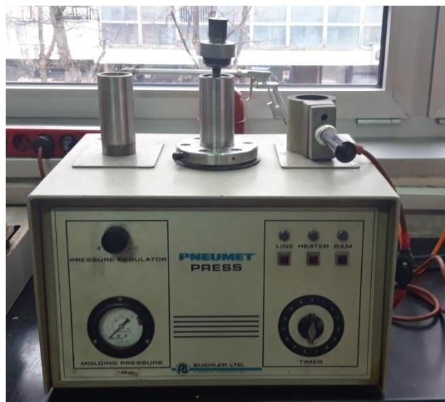
Slika 42. Uredaj za zalijevanje uzorka "PNEUMET PRESS" proizvođača Buehler LTD
