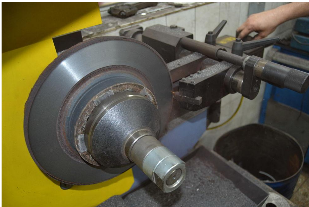
Slika 17. Tokarenje diskova prilikom izmjene disk pločica [14]
