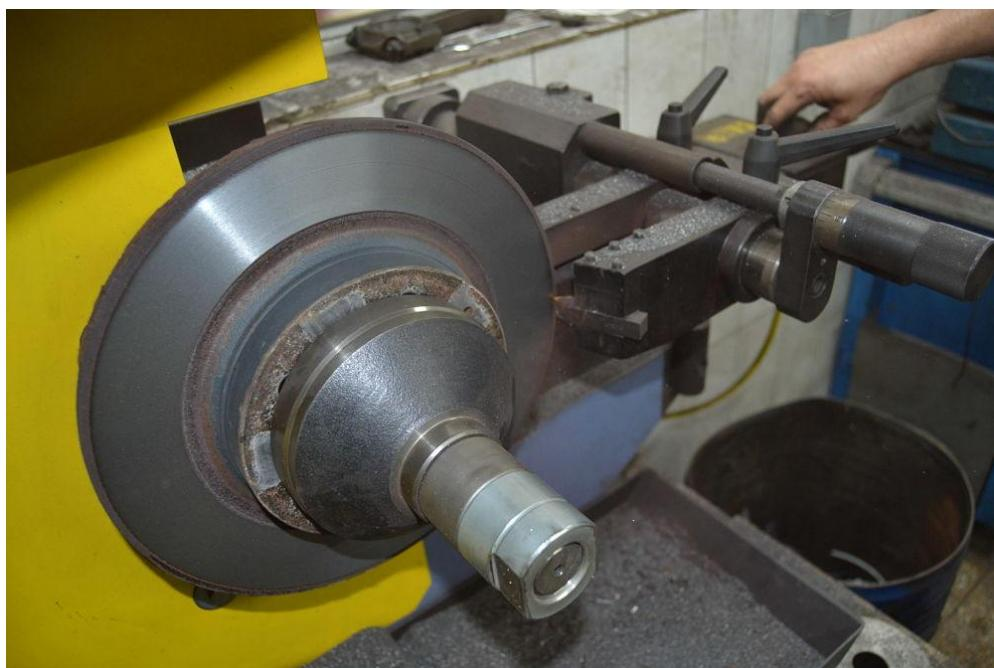
Slika 17. Tokarenje diskova prilikom izmjene disk pločica [14]
