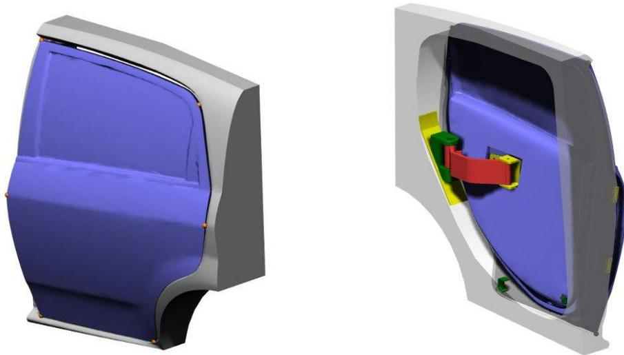
Slika 25. Model vrata s mehanizmom u visualNastran-u 4D
