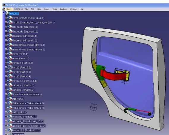
Slika 24. Sklop s mehanizmom za otvaranje vrata
