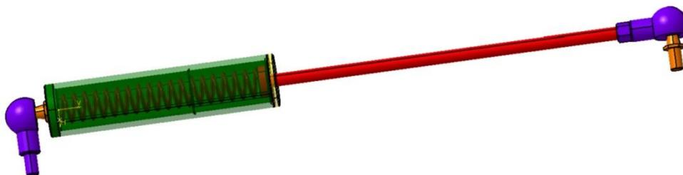
Slika 18. Model opružnog cilindra
