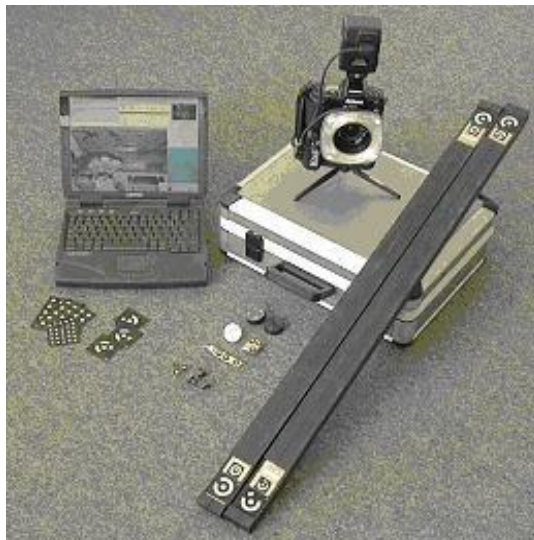
Slika 2. Fotogrametrijski sustav TRITOP (GOM mbH, Njemačka)
