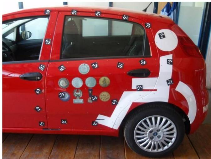
Slika 7. Postavljanje mjernih točaka (kodiranih i nekodiranih)
