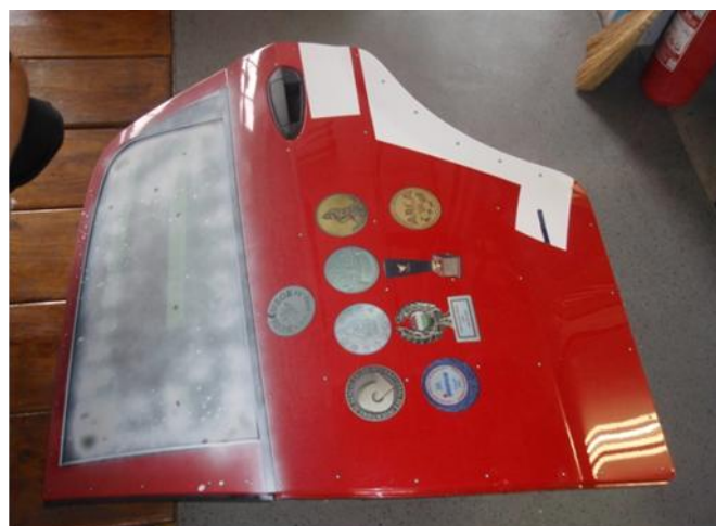
Slika 8. Postavljanje nekodiranih mjernih točaka na vratima
