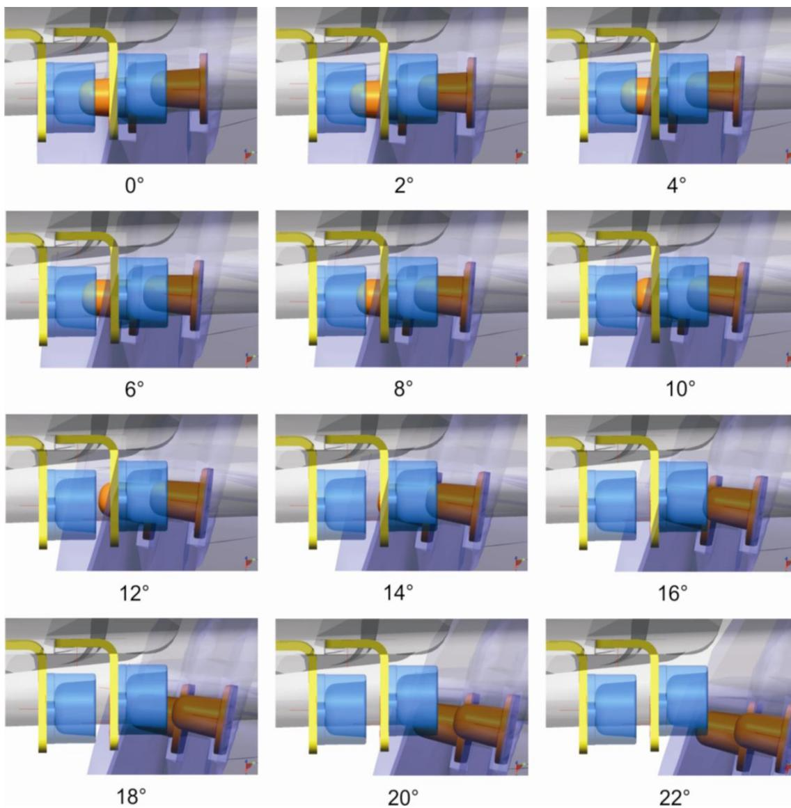
*Slika 32 Sekvencijalni prikaz zahvata vodilica prilikom otvaranja vrata*
