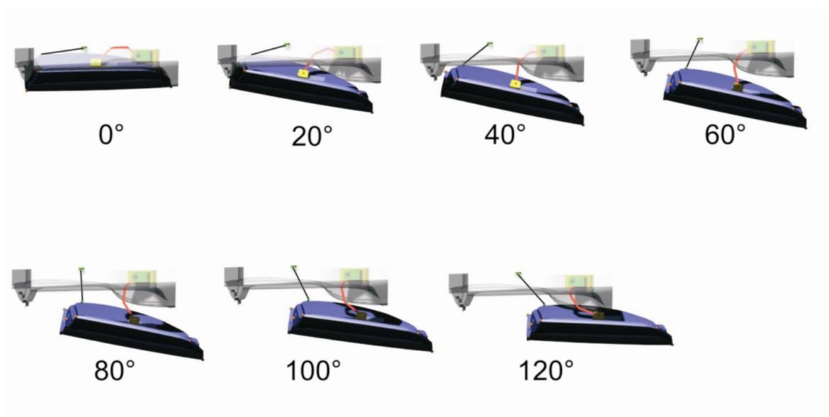
Slika 31. Sekvencijalni prikaz otvaranja vrata, pogled odozgo (tlocrt)
