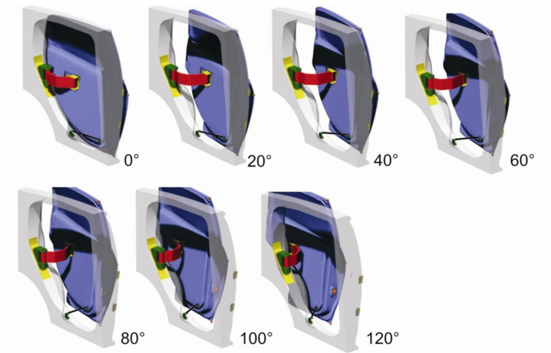
Slika 30. Sekvencijalni prikaz otvaranja vrata u izometriji
