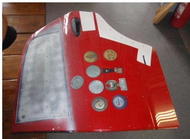
Slika 8. Postavljanje nekodiranih mjernih točaka na vratima
