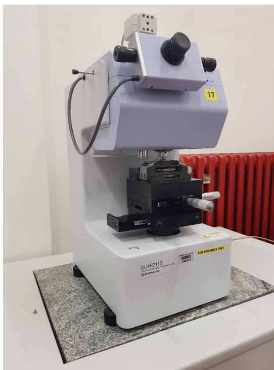
Slika 18. Tvrdomjer DUH-211 proizvođača Shimatzu, Japan
