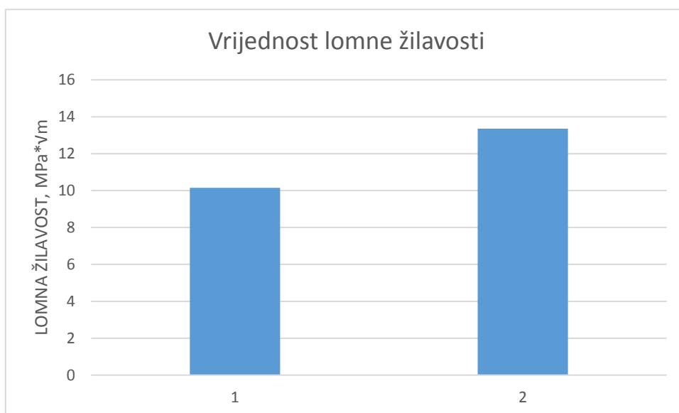
Slika 46. Usporedba lomne žilavosti uzoraka 1 i 2
