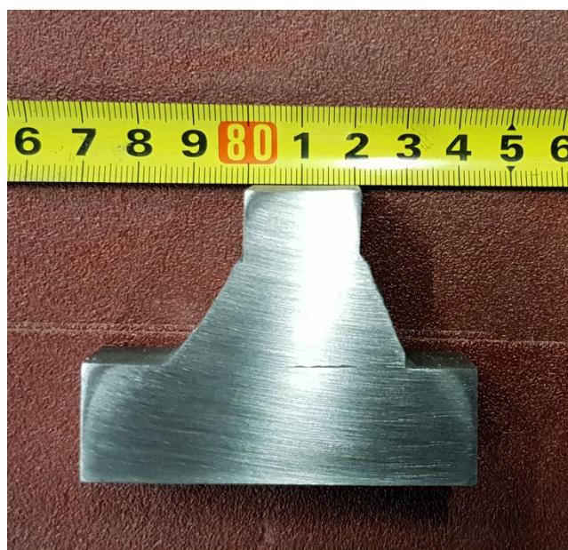
Slika 5.18 Makroizbrusak nakon operacije ručnog brušenja
