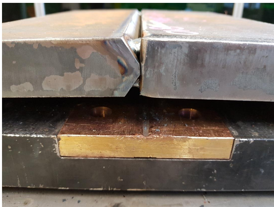
Slika 5.7 Pripremljen uzorak (2) bez krajnjih pločica
