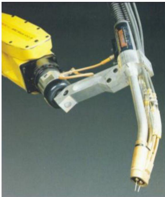
Slika 3.7 Pištolj za tandem postupak zavarivanja [8]
