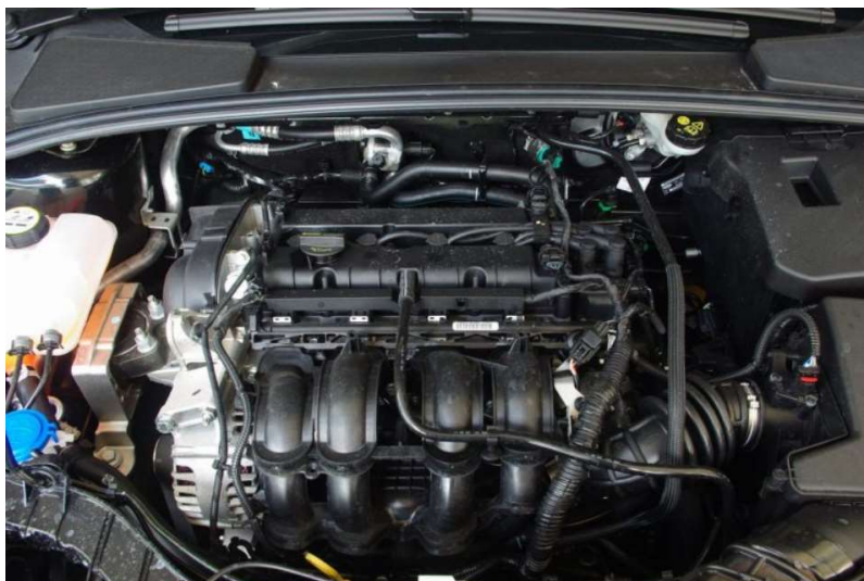
Slika 37. Motor 1.6 16V Duratec [22]
