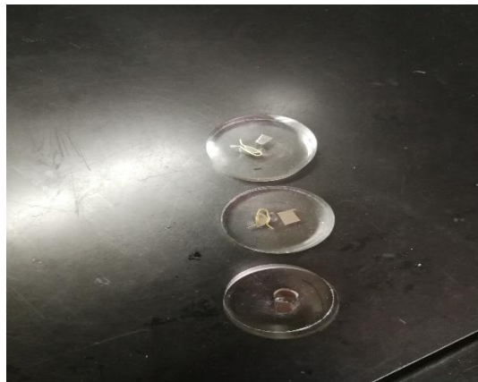
Slika 5.1 Uzorci uliveni u polimernu masu
