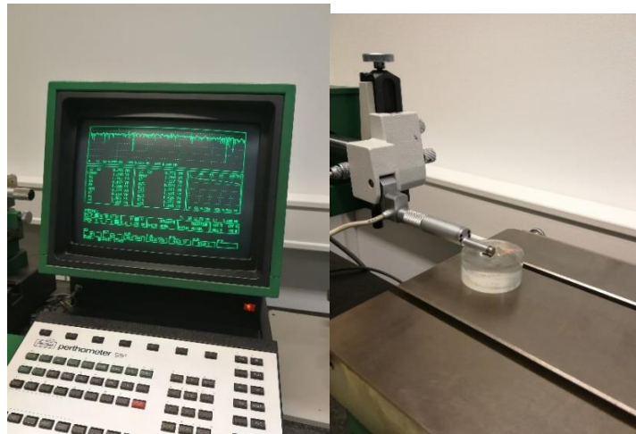
Slika 5.5 Uređaj Perthometer S8P za mjerenje hrapavosti površine
