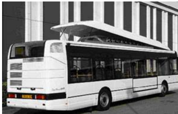
Slika 5.4. Montirani spremnici SPP-a na krovu gradskog autobusa
