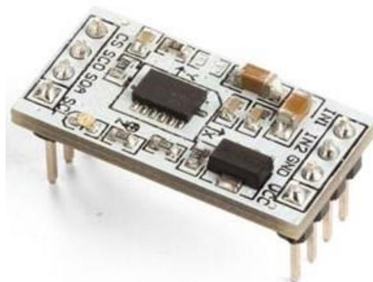
Slika 15. MMA7455 akcelerometar [15]
