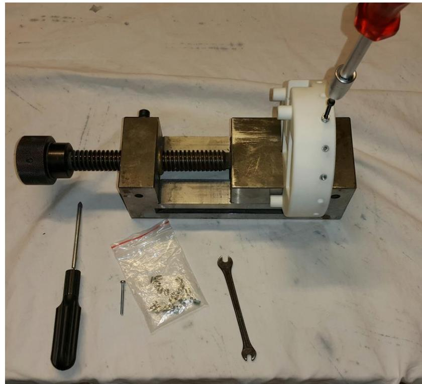
**Slika 40. Ugrađivanje metalnih navojnih uložaka**
