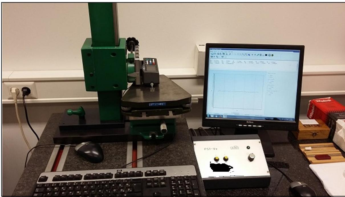
Slika 17. Time TR220 uređaj s ticalom za mjerjenje hrapavosti [1]
