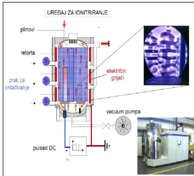
Slika 6. Shematski prikaz uređaja za ionsko nitriranje [16]
