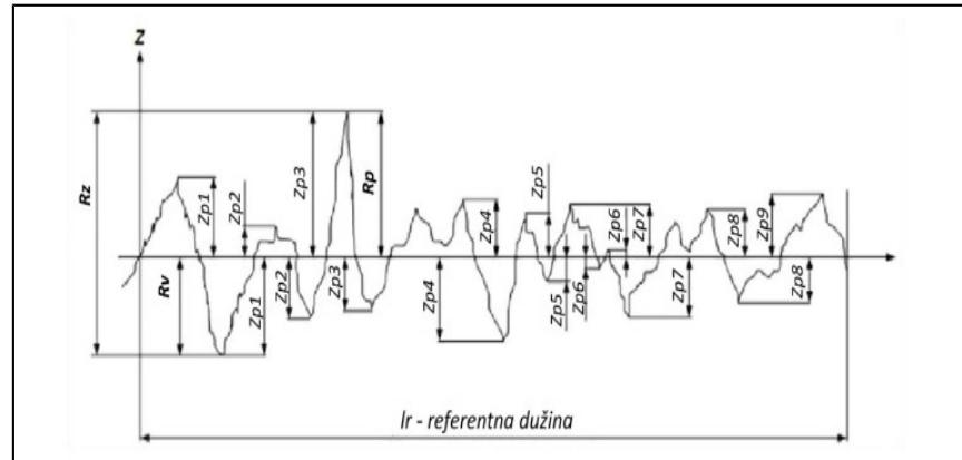
**Slika 19. Amplitudni parametri hrapavosti  $R_p$ ,  $R_v$  i  $R_z$  [1]**
