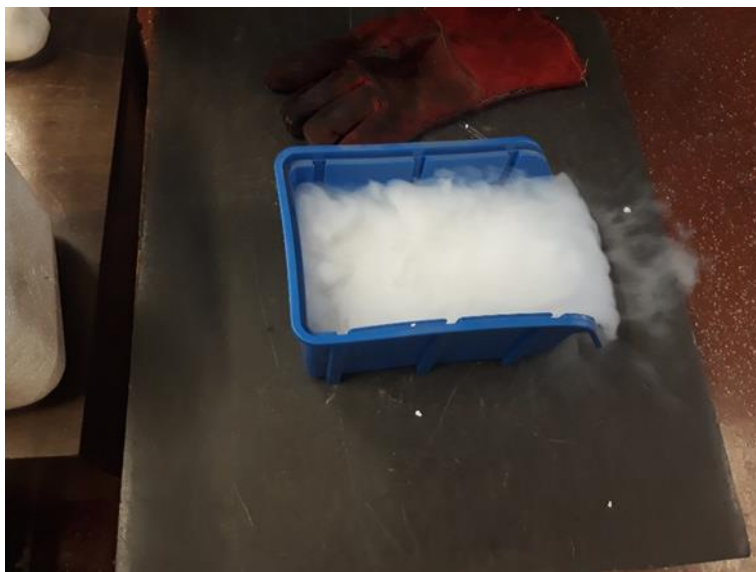
Slika 4.7. Ohlađivanje pomoću suhog leda i alkohola
