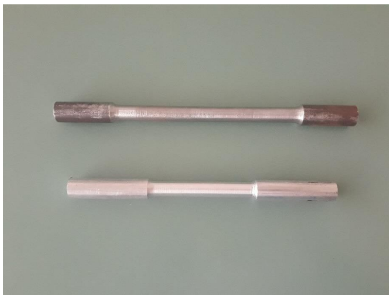
Slika 4.2. Epruvete za statičko vlačno ispitivanje na sniženim temperaturama
