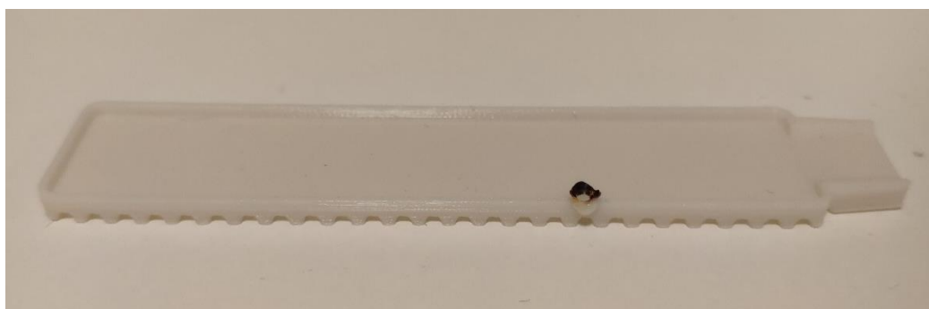
Slika 39. Greška u printeru nastala pregrijavanjem mlaznice
