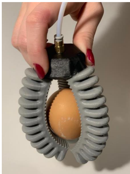
Slika 33. Testiranje treće prihvatnice
