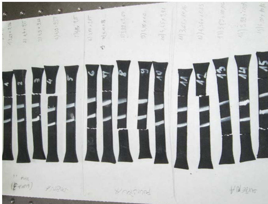
Slika 4.11. Epruvete nakon ispitivanja
