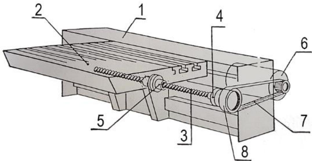
1-poprečni nosač, 2-stol, 3-kuglično navojno vreteno (KNV), 4-uležištenje KNV
