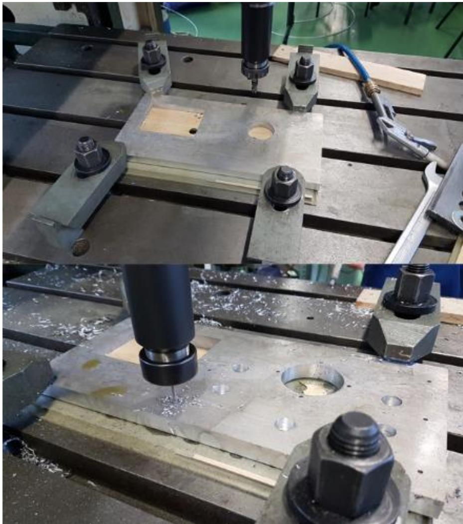
Slika 21. Obrada prednje ploče vodilice u drugom stezanju
