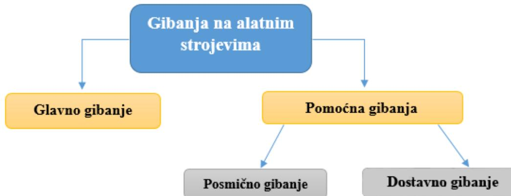
Slika 3. Podjela gibanja na alatnim strojevima [3]
