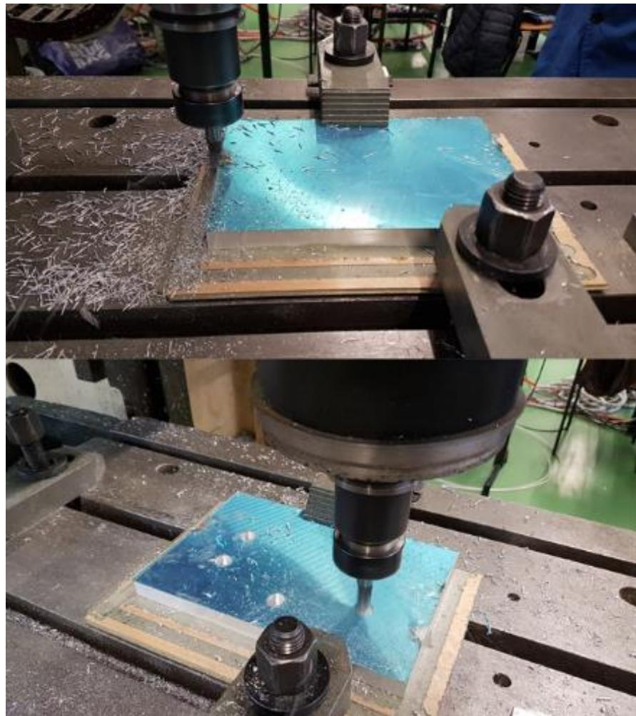
Slika 18. Obrada stražnje ploče vodilice u drugom stezanju
