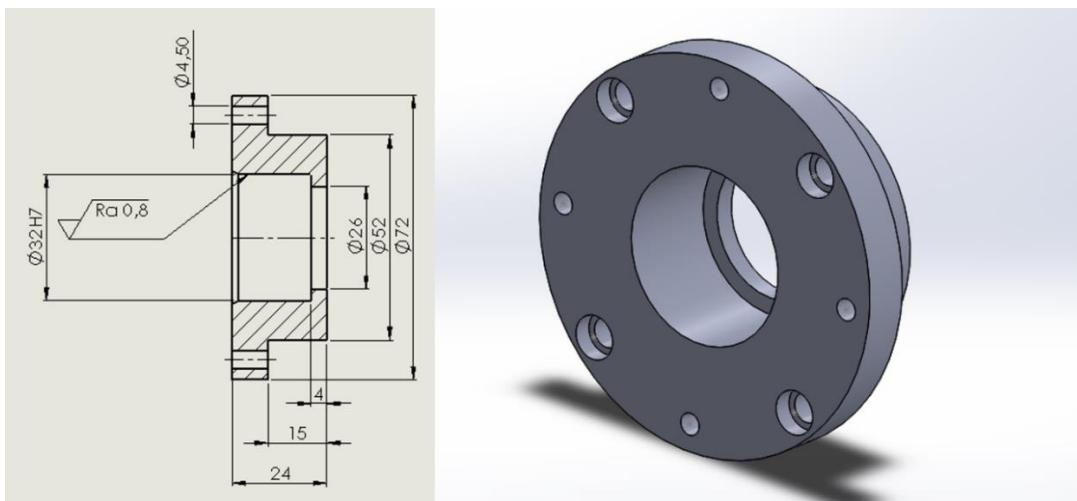
Slika 25. Kućište prednjeg ležaja - dimenzije i CAD model
