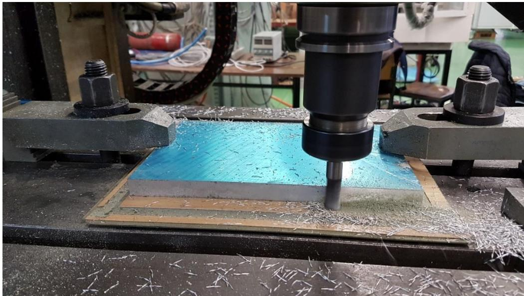
Slika 17. Obrada stražnje ploče vodilice u prvom stezanju
