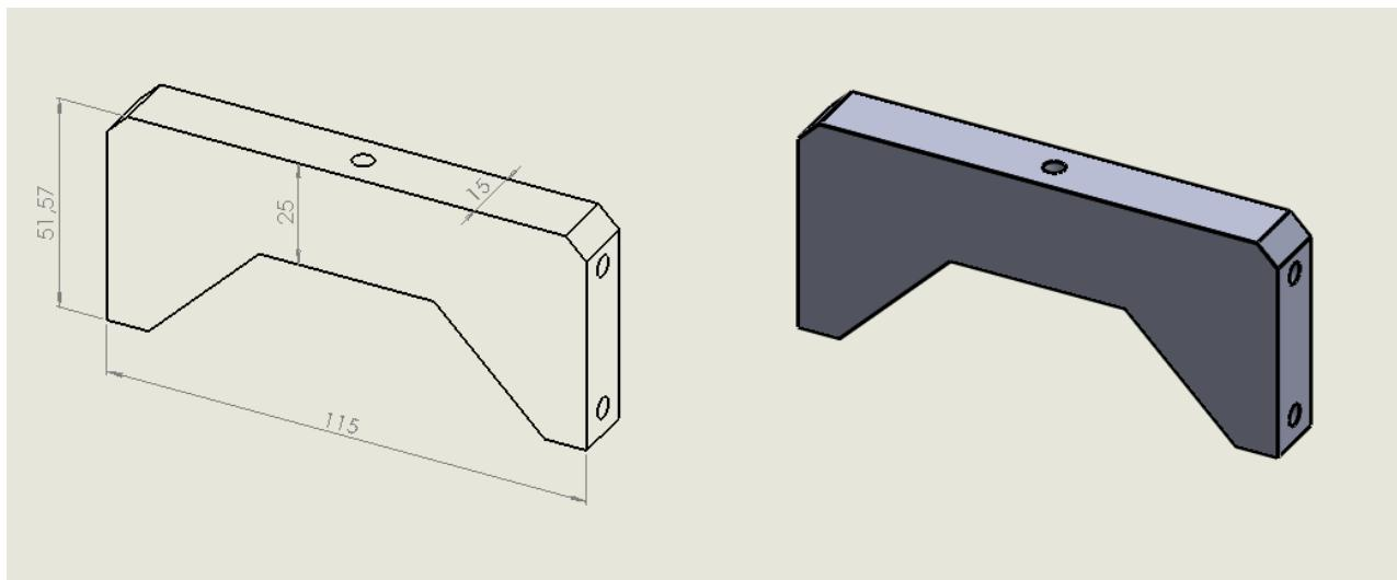
Slika 33. Spojna ploča - vanjske dimenzije i CAD model
