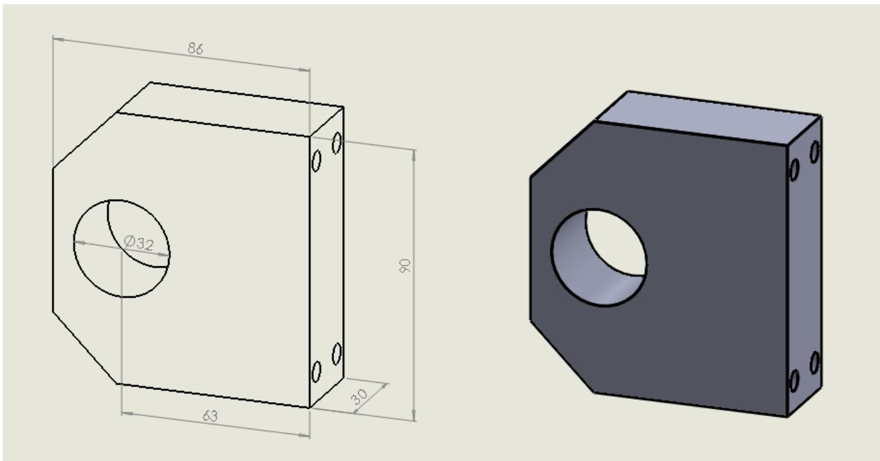
Slika 29. Kućište stražnjeg ležaja – dimenzije i CAD model
