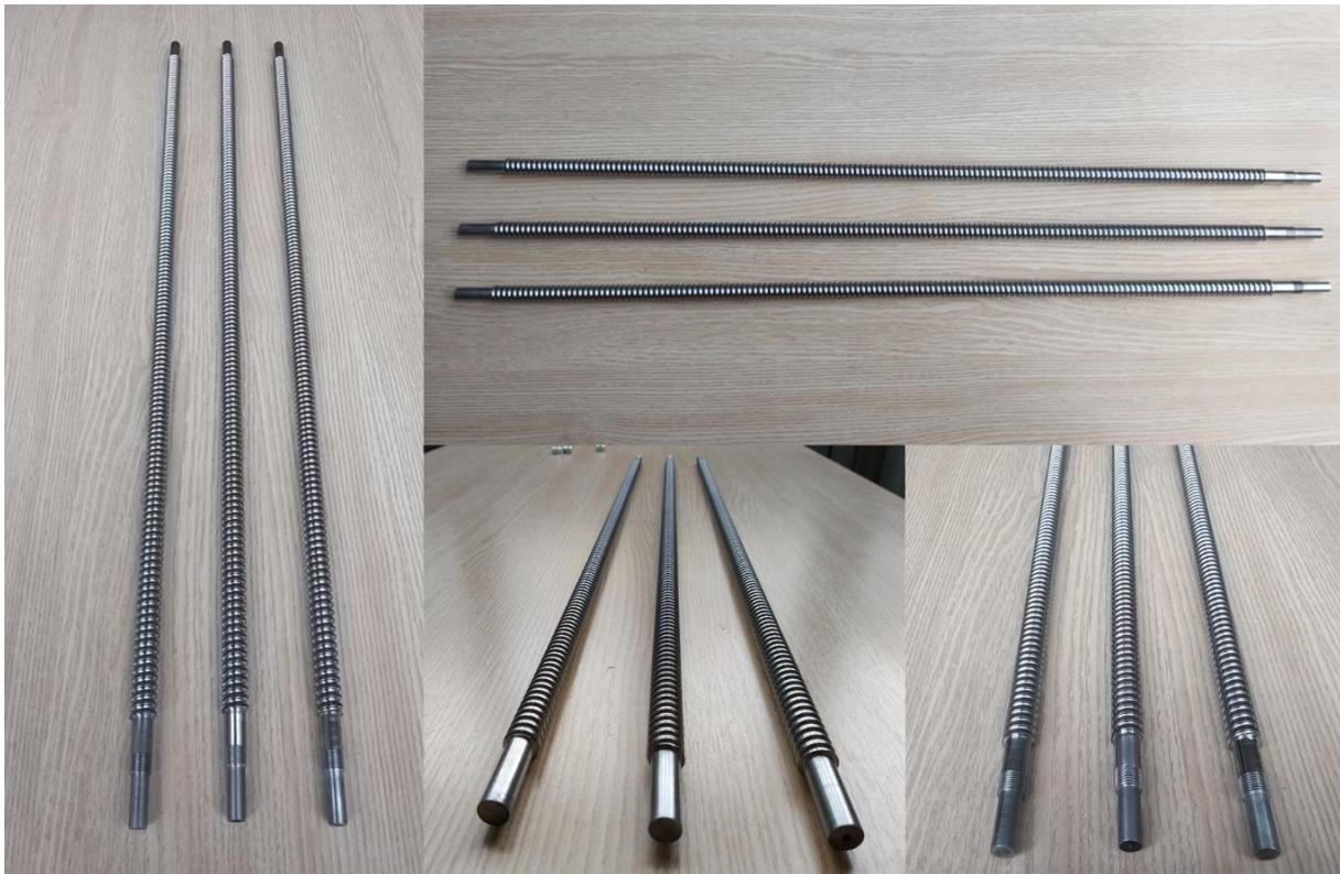
Slika 38. Izrađene pozicije kugličnog navojnog vretena
