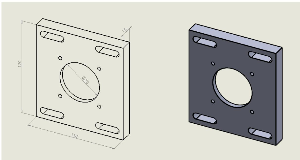
Slika 32. Pločica motora- vanjske dimenzije i CAD model
