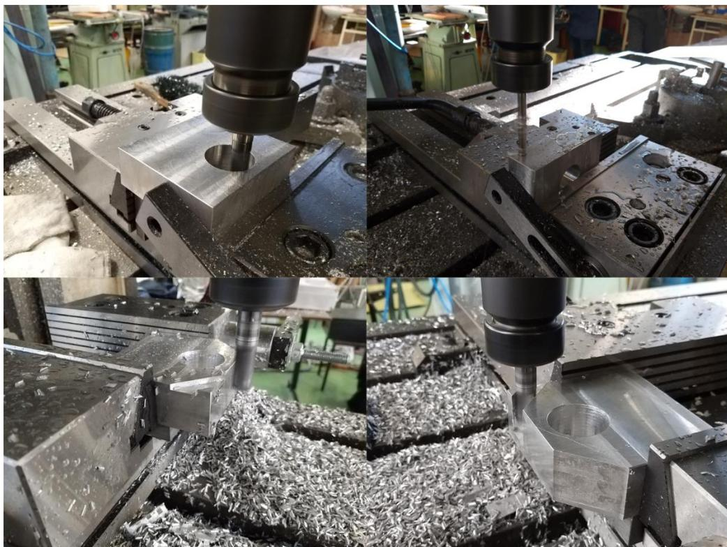
Slika 30. Izrada kućišta stražnjeg ležaja
