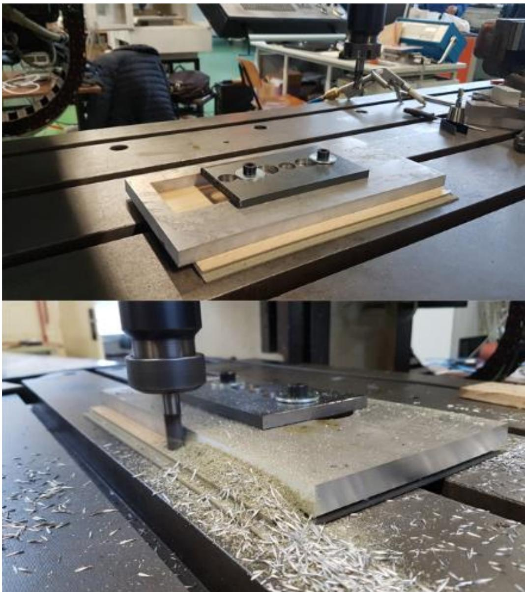
Slika 20. Obrada prednje ploče vodilice u prvom stezanju
