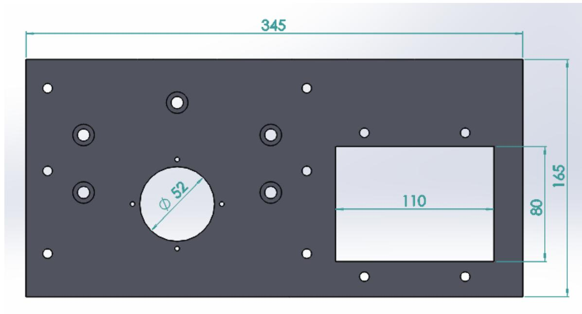
Slika 19. Prednja ploča vodilice CAD model
