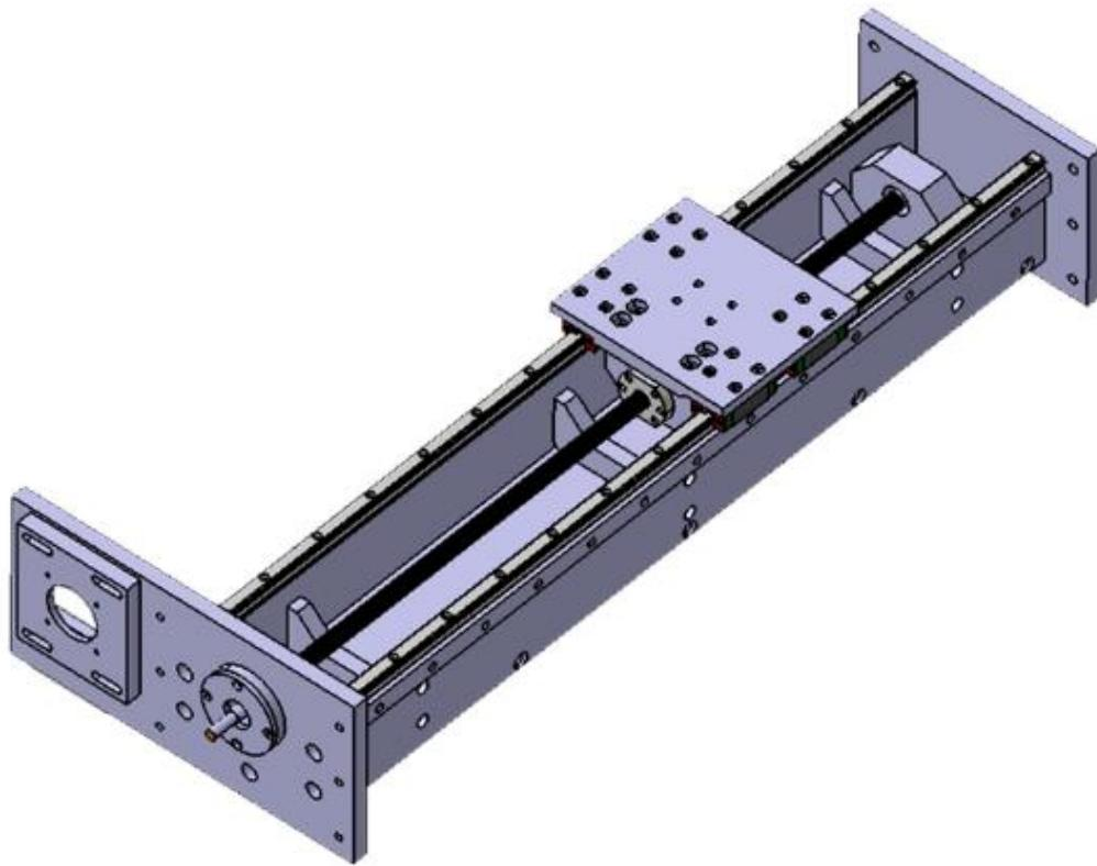
Slika 14. CAD model sklopa konstrukcije modula posmičnog prigona
