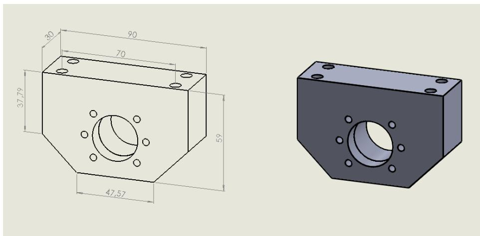
Slika 48. Kućište matice – vanjske dimenzije i CAD model
