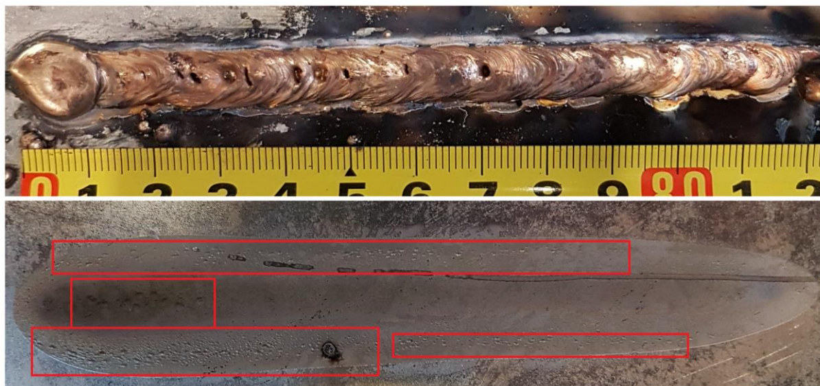
Slika 37. Uzorak 3C: - gornja slika: lice zalemljenog spoja - donja slika: naličje zalemljenog spoja
