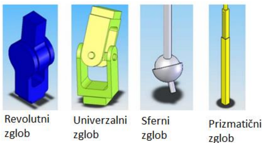
Slika 7. Redom s lijeva na desno prikazani revolutni, univerzalni, kuglični te prizmatični spoj [10]
