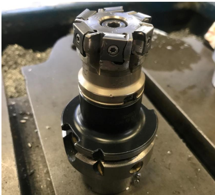
Slika 31. ISCAR glodalo za poravnavanje
