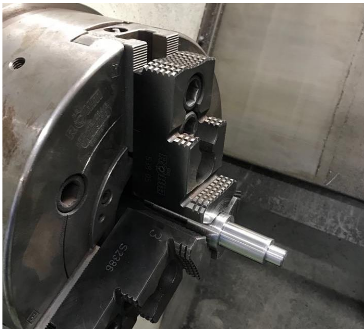
Slika 22. Tokarenje osnovnog oblika osovine 1 na CNC tokarilici
