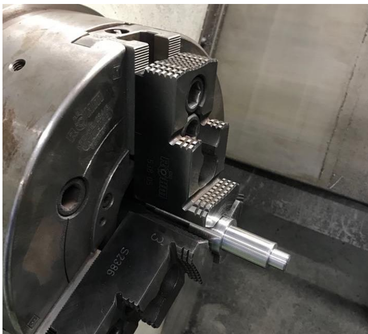
Slika 22. Tokarenje osnovnog oblika osovine 1 na CNC tokarilici
