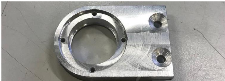
Slika 20. Konačan izgled držača ležaja
