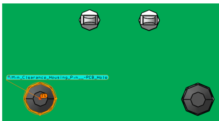
Slika 28. Izmjera zračnosti svornjaka i provrta PCB pločice
