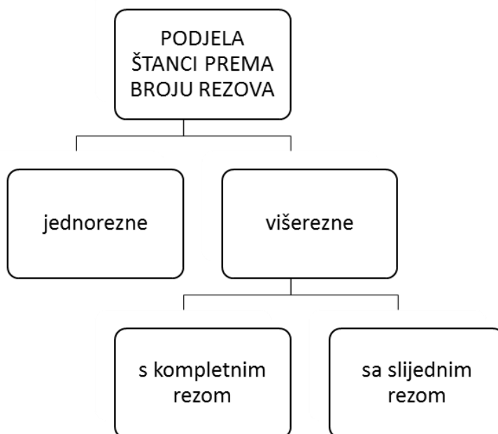
Slika 22. Podjela štanci prema broju rezova [9]
