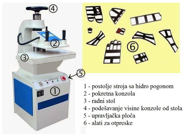
Slika 5. Preša za štancanje kože [8]
