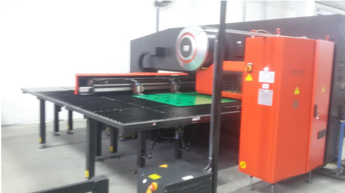
Slika 56. Lim u tijeku procesa probijanja
