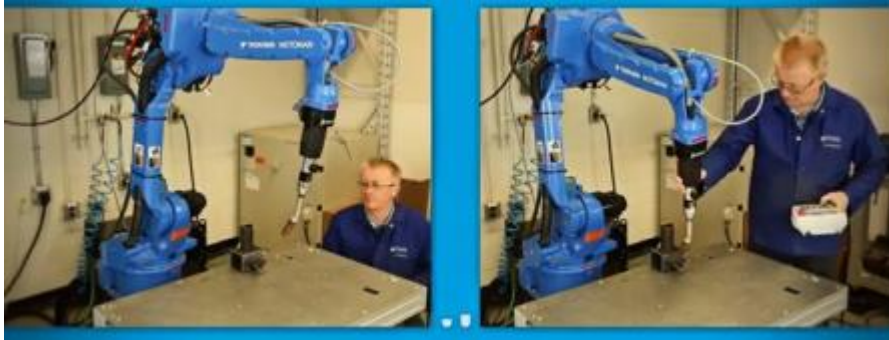
Slika 12. On-line programiranje robota [9]
