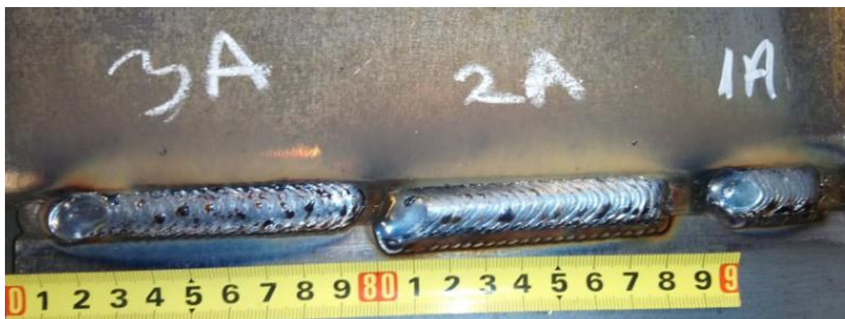
Slika 38. Zavari na uzorku A, utjecaj parametara njihanja
