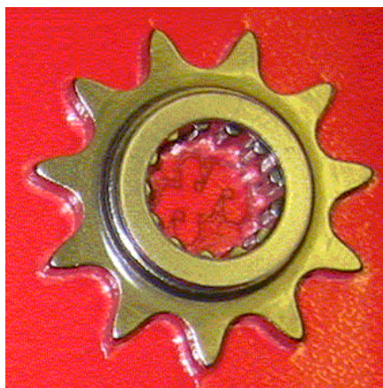
Slika 5.2. Manji (pogonski) lančanik 11 , z=11 zubi.
