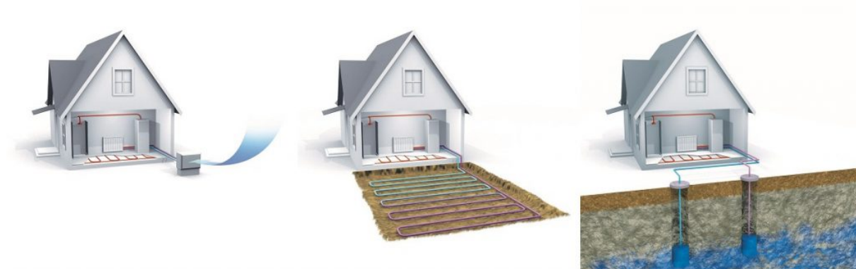
Slika 2. Prikaz izvora topline – zrak, tlo ili voda
