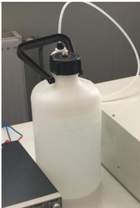
Slika 25. Unutarnji spremnik vode sa sustavom finog pročišćivanja
