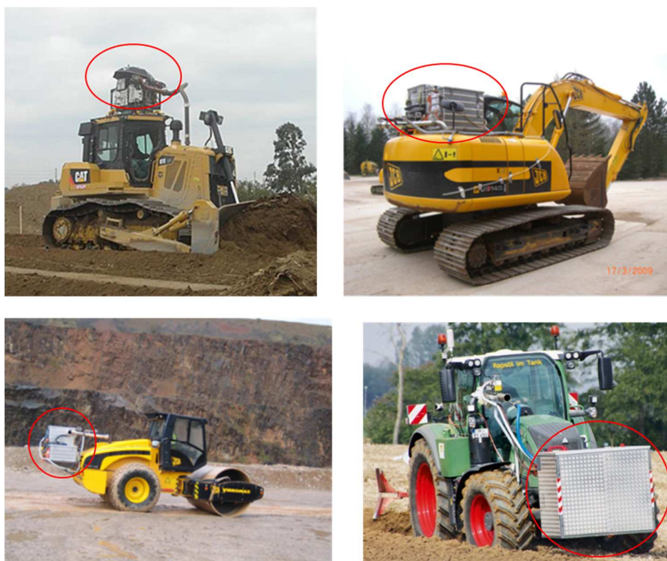
Slika 40. Primjeri stvarnih izvedbi smještaja PEMS uređaja na veće strojeve
