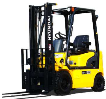
Slika 3. Viličar Hyundai 18D-7E, Dieslov motor snage 30,8 kW, pripada potkategoriji NRE-v-3 [6]
