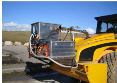
Slika 43. Primjer smještaja PEMS uređaja na odgovarajuće mjesto
