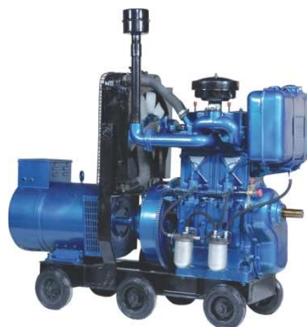
Slika 4. Atul agregat hladen vodom, dvocilindarski Dieslov motor pokreće generator izmjenične struje; izvedbe od 8 kW do 16 kW, pripadaju potkategoriji NRE-c-2 [7]
