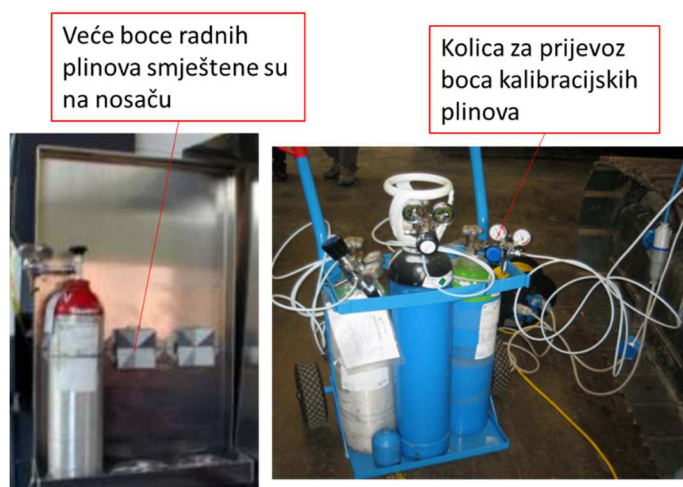
Slika 49. Manje boce radnog plina mogu se pričvrstiti na nosač PEMS opreme dok je za veće potreban nosač pomoću kojeg će biti osigurane na mjestu; kalibracijski plinovi nose se na teren ili se umjeravanje vrši u laboratoriju
