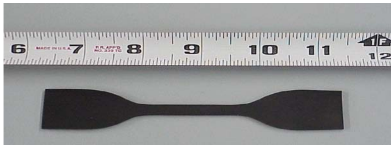
Slika 7. Epruveta za ispitivanje mehaničkih svojstava elastomera (gume) [7]
