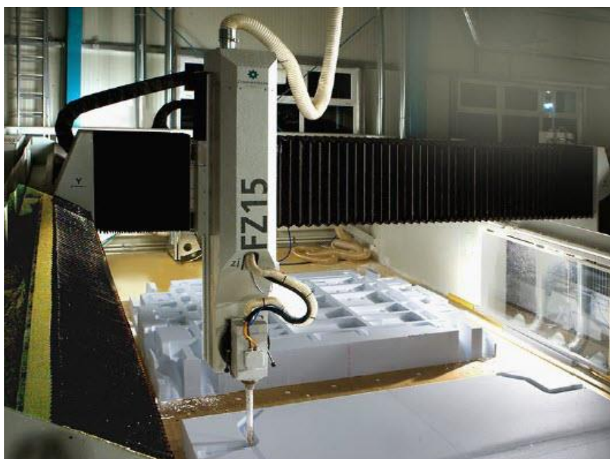
Slika 53. Izrada modela za lijevanje od polistirena, [5]
