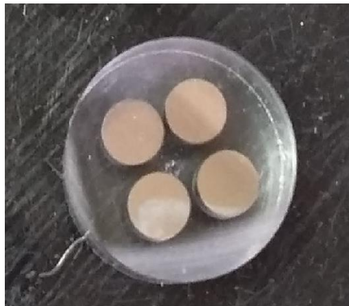
Slika 26. Uzorci za metalografsko ispitivanje
