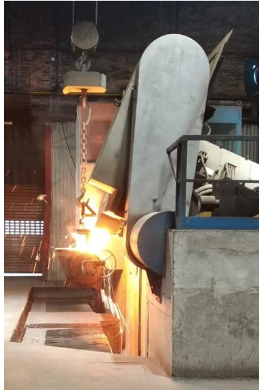
Slika 14. Ispust primarne taljevine u lonac za obradu
