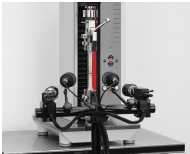
Slika 4. Moderni optički ekstenzometar [13]
