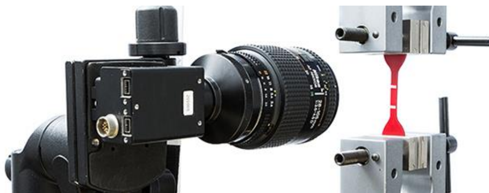
Slika 6. Suvremeni video ekstenzometar [13]
