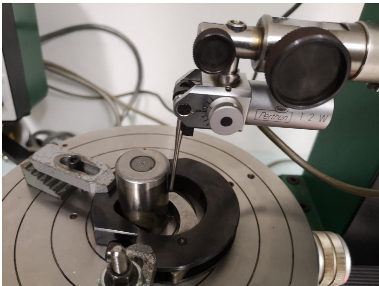
Slika 52. Početni položaj prvog mjerenja „Donaldson reversal“ metode
