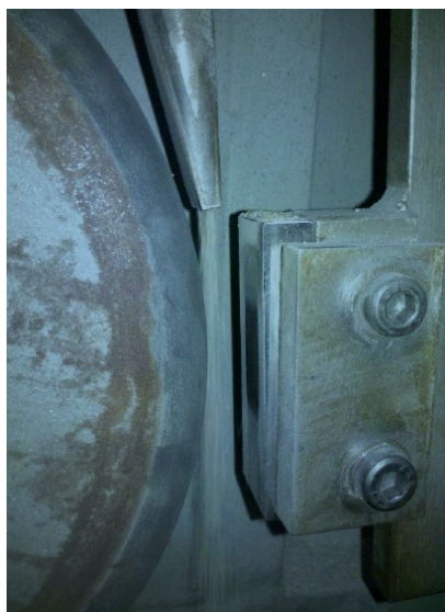
Slika 18. Detalj uređaja i trag trošenja na uzorku [7]
