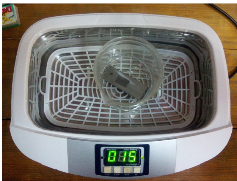
Slika 39. Čišćenje ispitnog uzorka u ultrazvučnoj kupki
