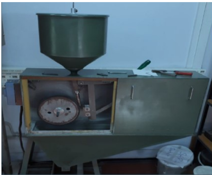
Slika 20. Uređaj za ispitivanje otpornosti na abrazijsko trošenje [7]
