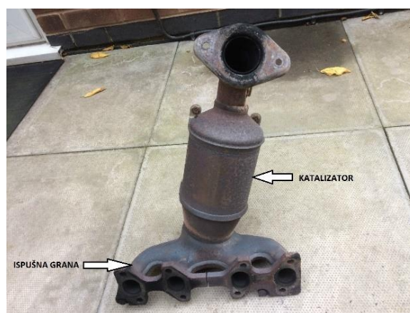
Slika 11. Lijevo: Smještaj originalne ispušne grane FIAT-a Punta; Desno: Ispušne cijevi i katalizator
