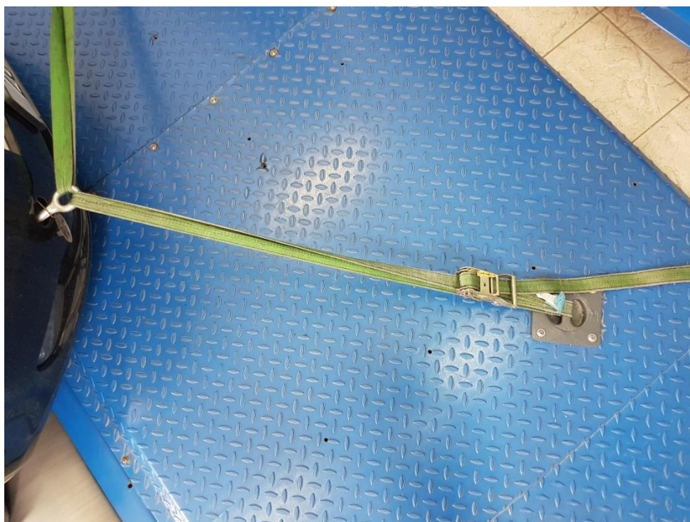
Slika 17. Osiguranje prednjeg kraja vozila od ispadanja iz mjernih valjaka
