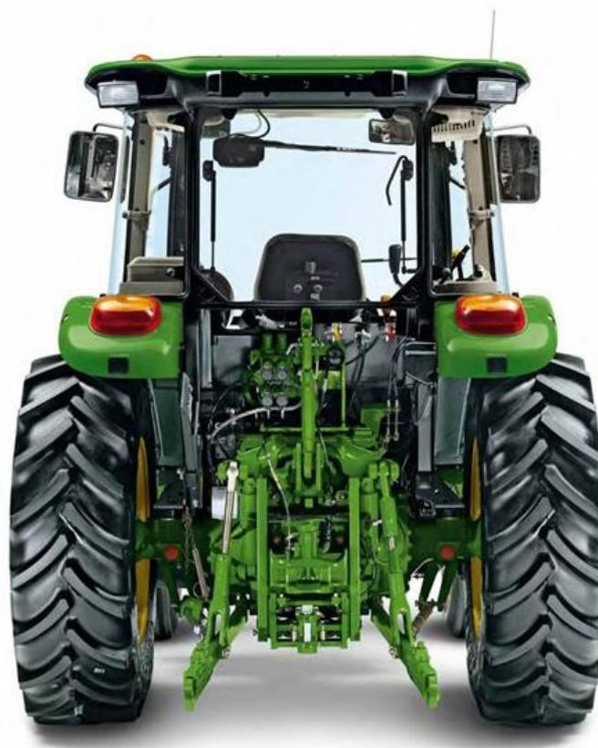
**Slika 5. Pozicija poteznice na traktoru**
