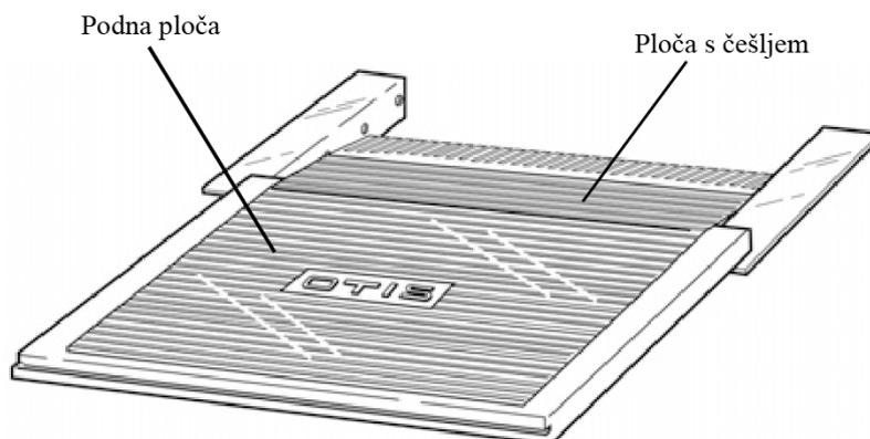
**Slika 16. Podna ploča i ploča s češljem [11] (adaptirano)**
