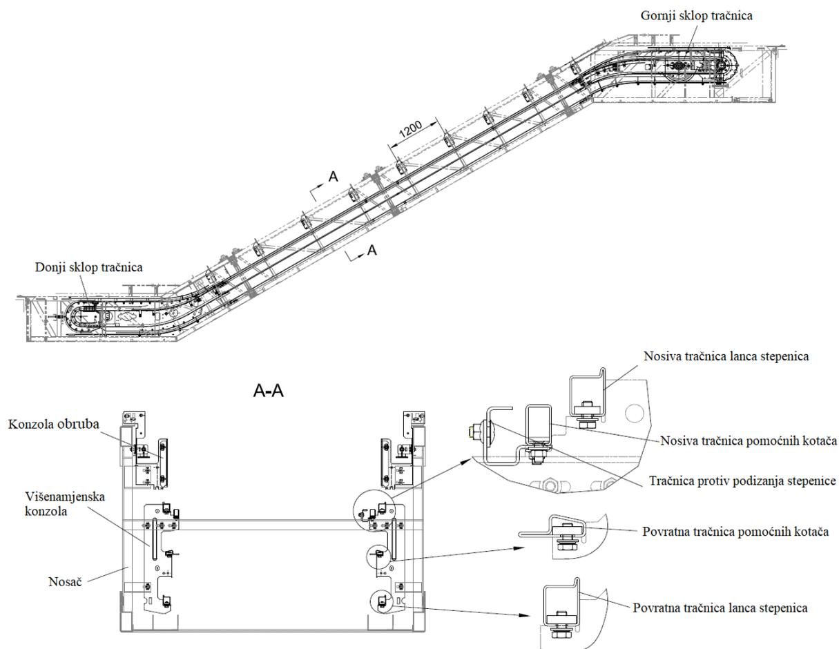
Slika 10. Tračnice pokretnih stepenica i presjek kosog dijela [9]
