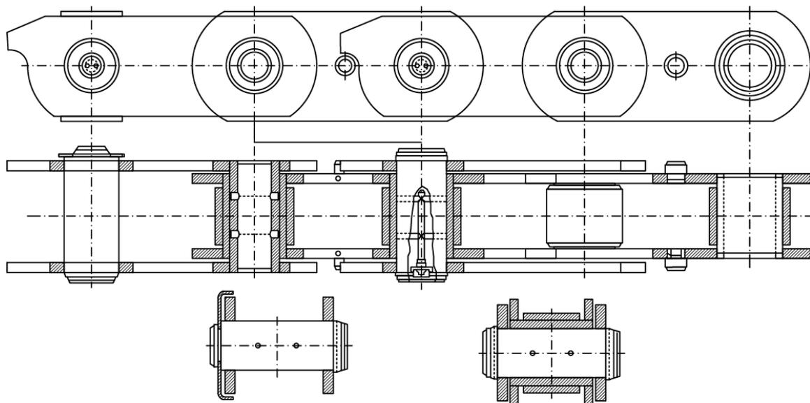
Slika 22. Lanac stepenica bez kotača [1] (adaptirano)
