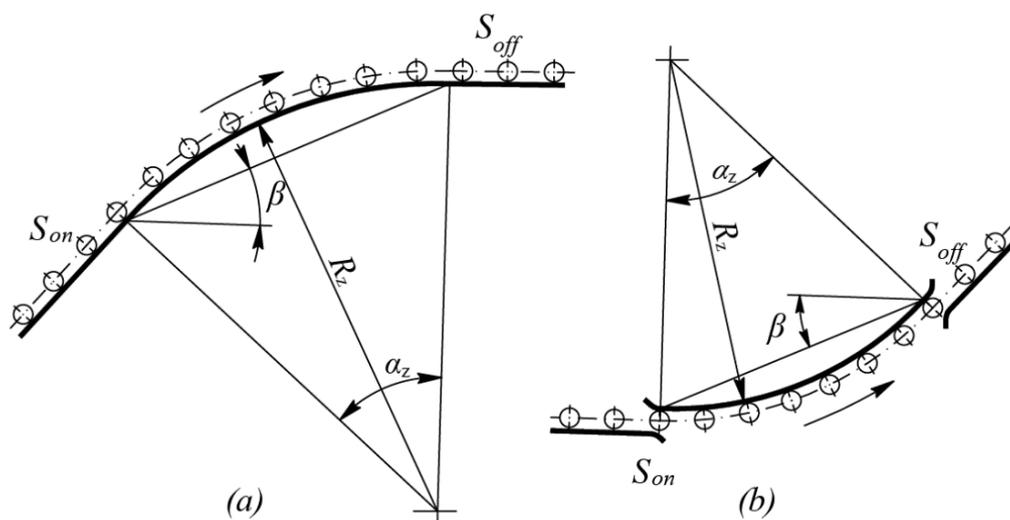
Slika 45. Karakteristike za otpore na zaobljenom dijelu [1] (adaptirano)
