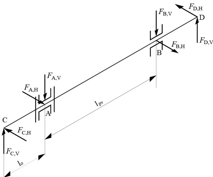
Slika 51. Opterećenje pune osovine
