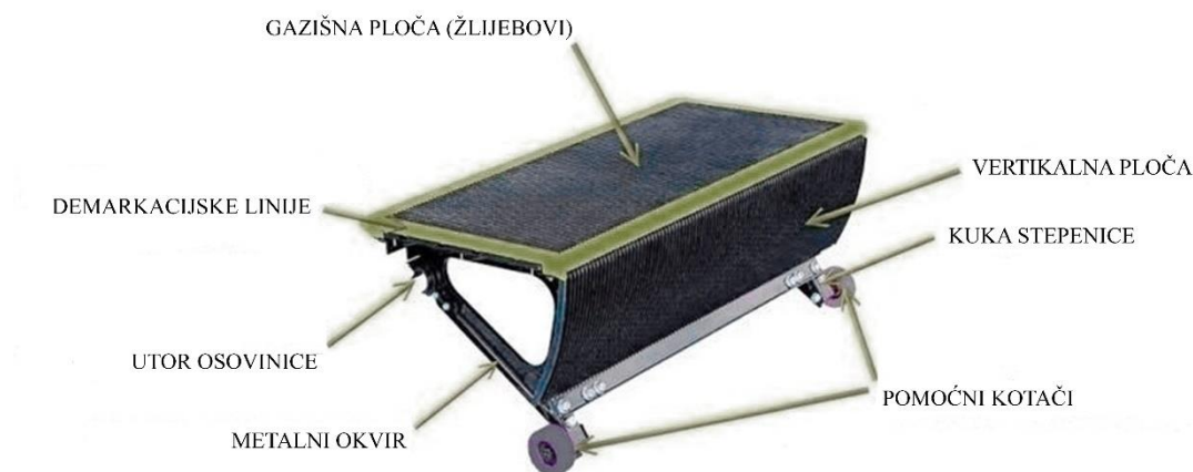
Slika 12. Struktura stepenice [10] (adaptirano)
