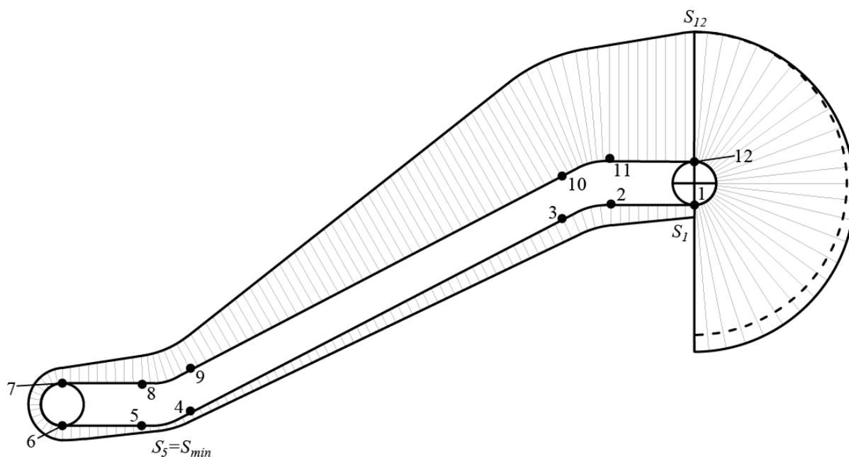
**Slika 46. Kvalitativni prikaz napregnutosti lanca po točkama**
