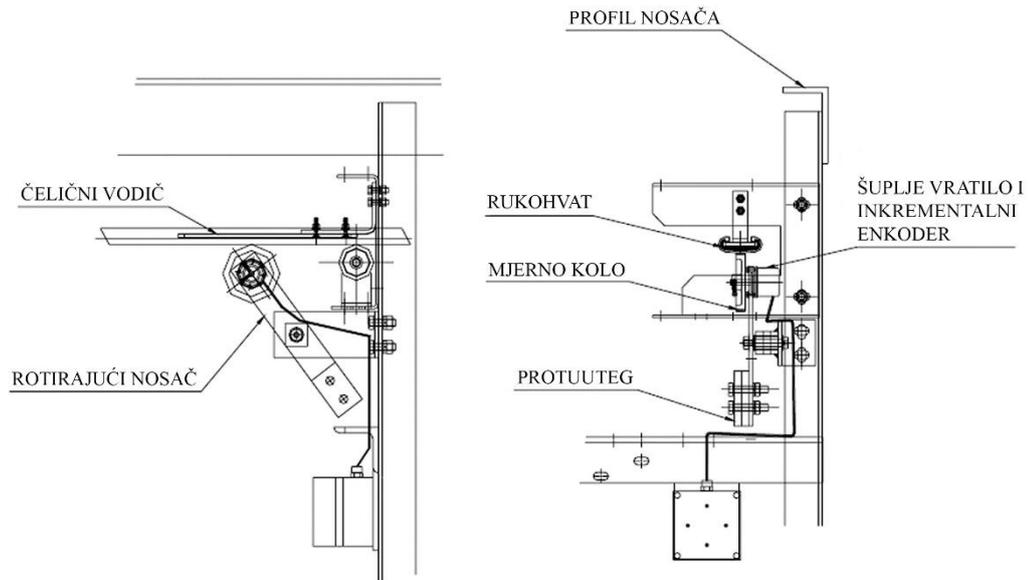
Slika 32. Uređaj za mjerenje brzine rukohvata [21]
