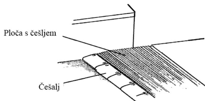
**Slika 17. Ploča s češljem i segmenti češlja [12]**
