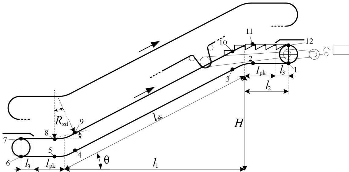
Slika 44. Geometrijske karakteristike pokretnih stepenica [24] (adaptirano)
