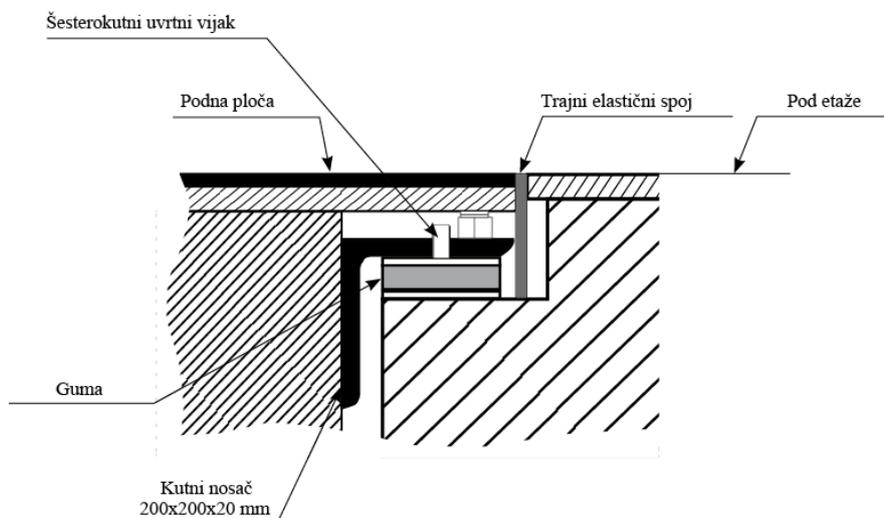
Slika 8. Primjer fiksiranog dijela nosača [2] (adaptirano)
