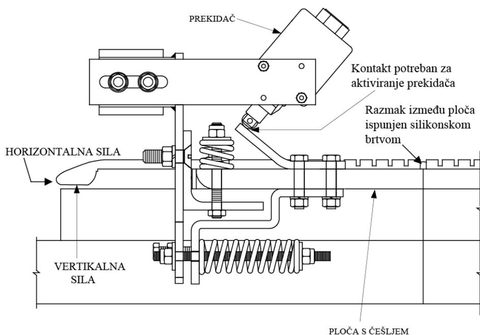
Slika 29. Sigurnosni uređaj za ploču s češljem [22] (adaptirano)
