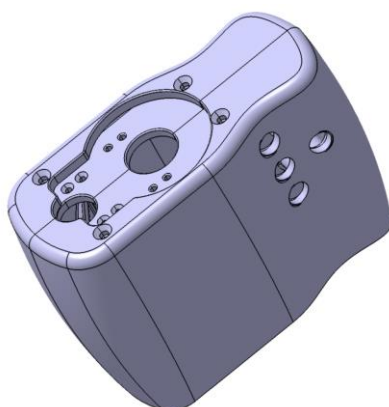
Slika 29. Spoj okvira i prirubnice
