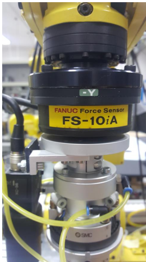
Slika 15. Senzor sile FS - 10iA
