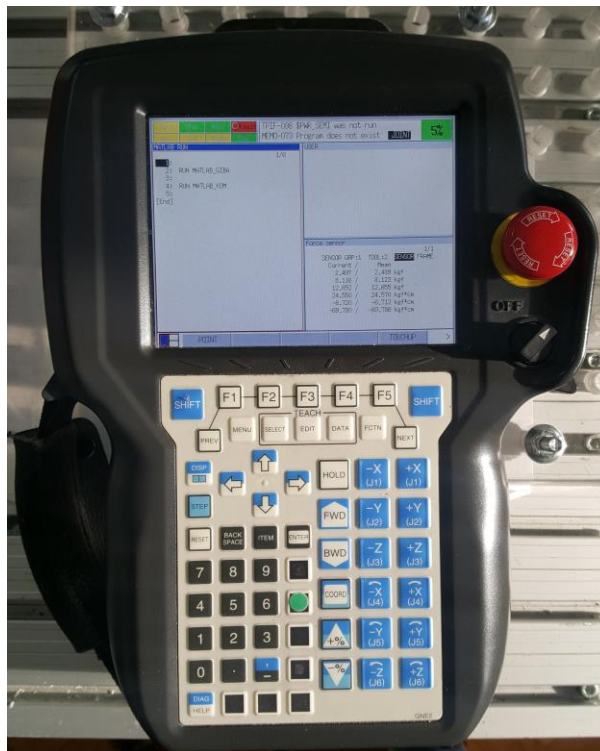
Slika 14. Upravljačka konzola (eng. Teach Pendant )
