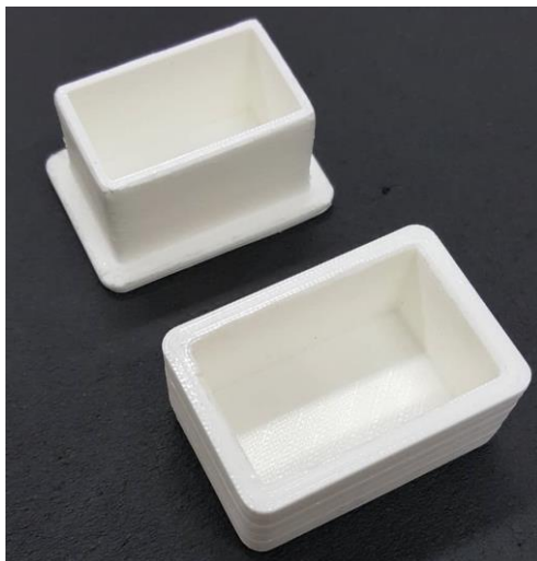
Slika 51. Isprintani 3D modeli kutije i poklopca
