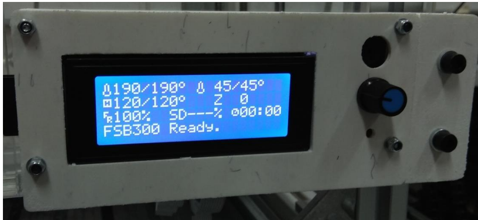
Slika 4.16. Postignuta temperatura u grijanoj komori
