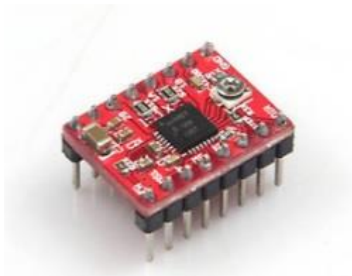
Slika 4.12. Upravljač koračnim motorima A4988
