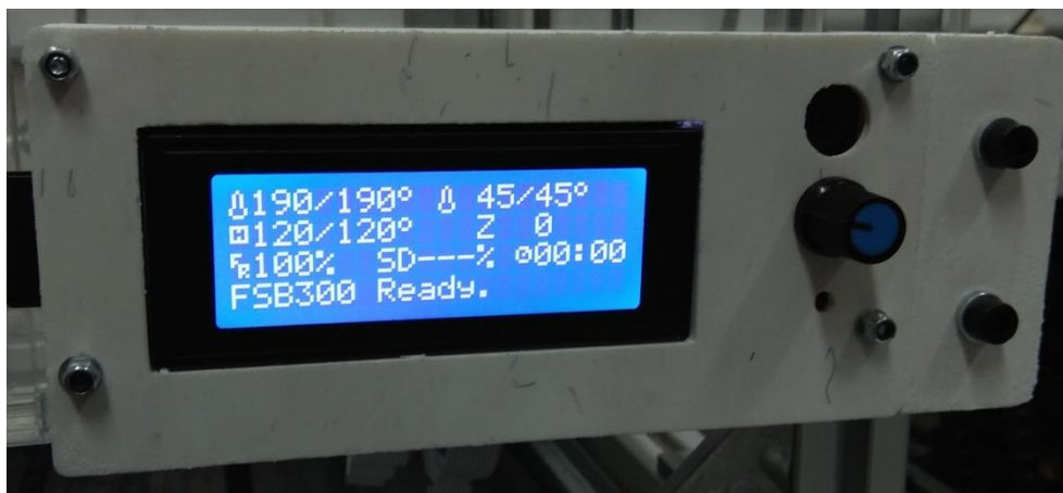
Slika 4.16. Postignuta temperatura u grijanoj komori
