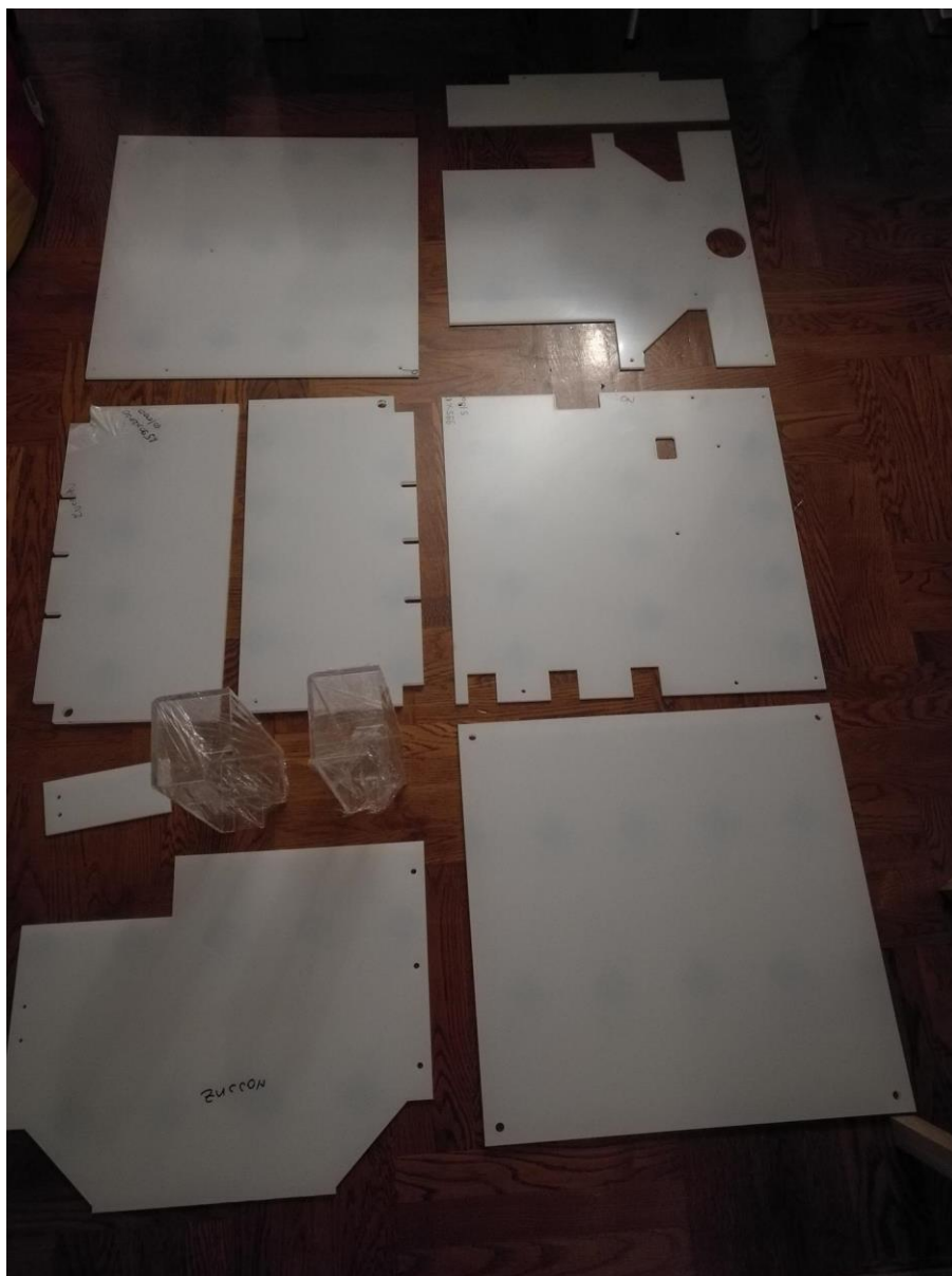
Slika 4.4. Izrađene ploče za grijanu komoru
