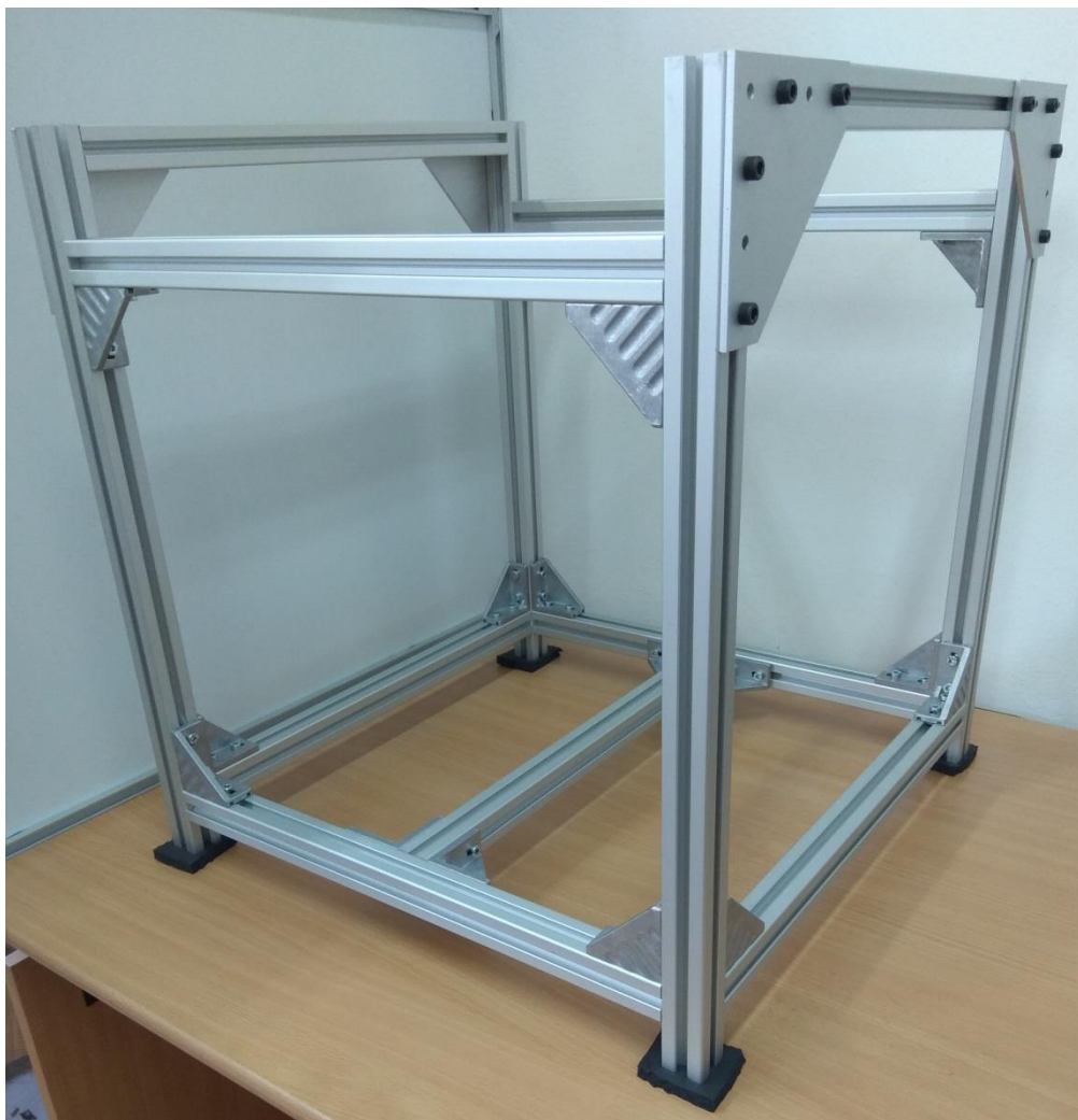
Slika 4.5. Okvir 3D tiskača sa grijanom komorom
