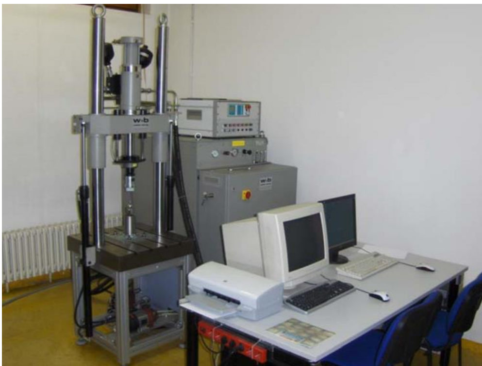
Slika 27. Servohidraulička umaralica LFV-50-HH
