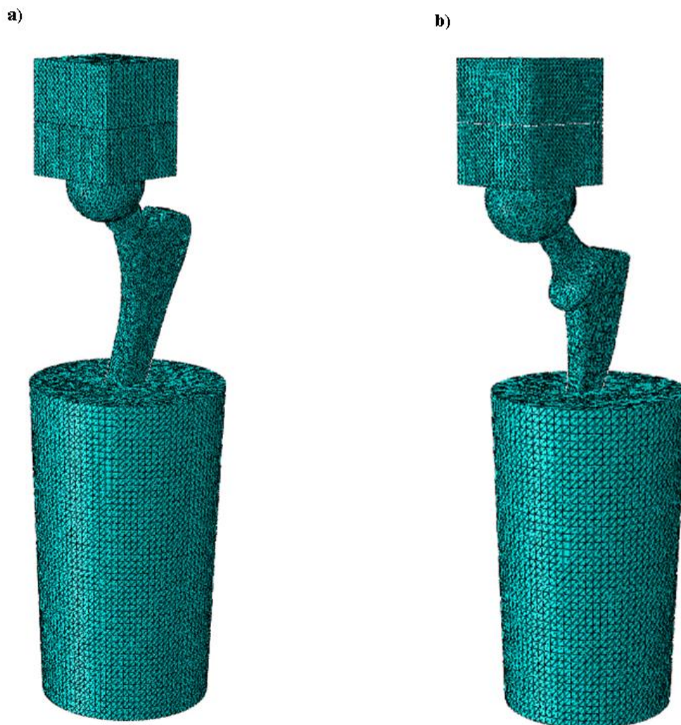
Slika 40. Generirana mreža na modelima: a) model 1 i b) model 2
