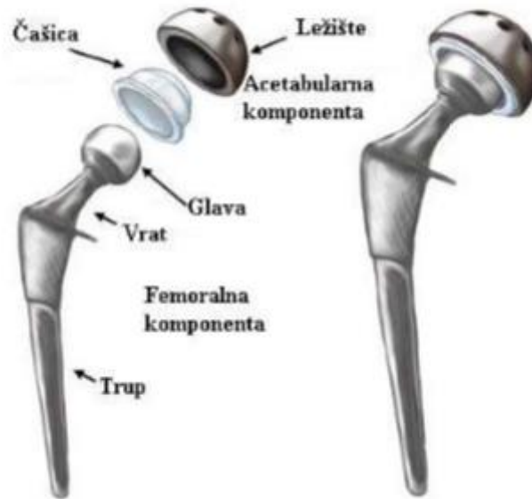
Slika 8. Dijelovi endoproteze zgloba kuka [7]
