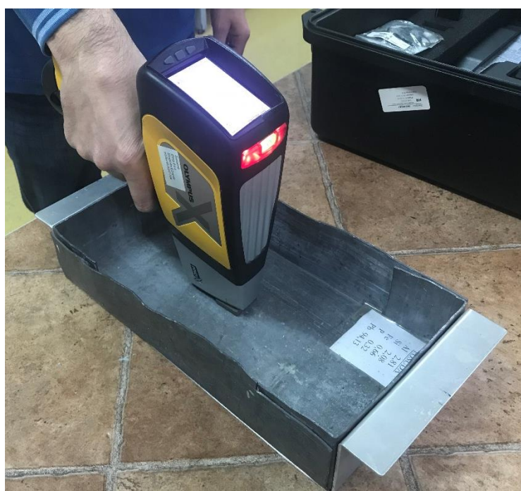
Slika 6.5. Postupak ispitivanja XRF uređajem
