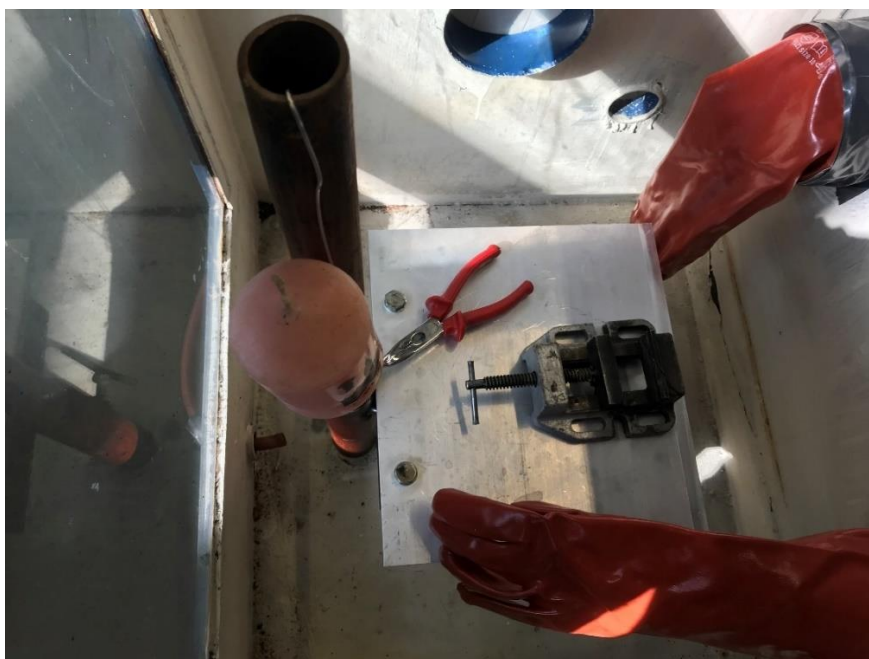
Slika 6.9. Unutrašnjost komore za zavarivanje
