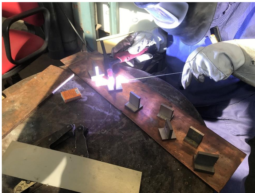
Slika 6.13. Postupak spajanja uzoraka
