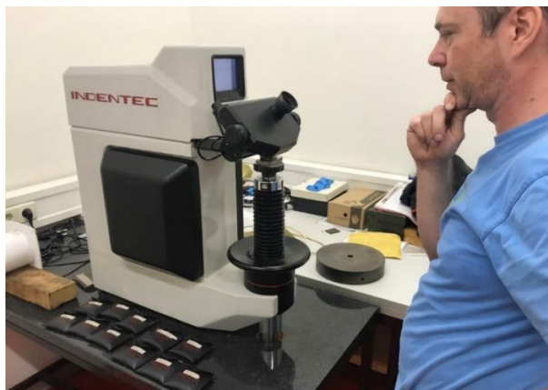
Slika 6.22. Postupak ispitivanja tvrdoće uzoraka
