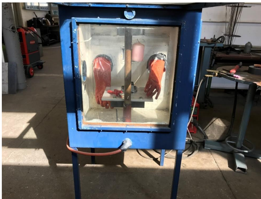
Slika 6.8. Komora za zavarivanje
