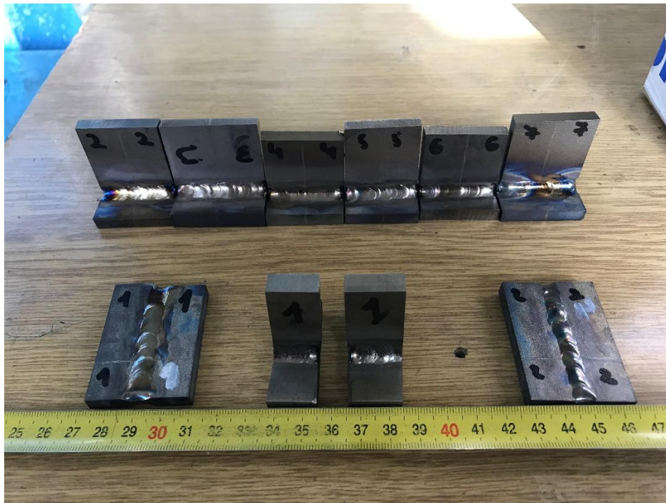
Slika 6.18. Uzorci nakon obrade odvajanjem čestica
