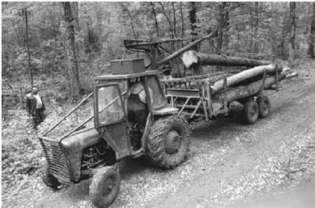
**Slika 2. Prikolica s hidrauličnom dizalicom u primjeni**
