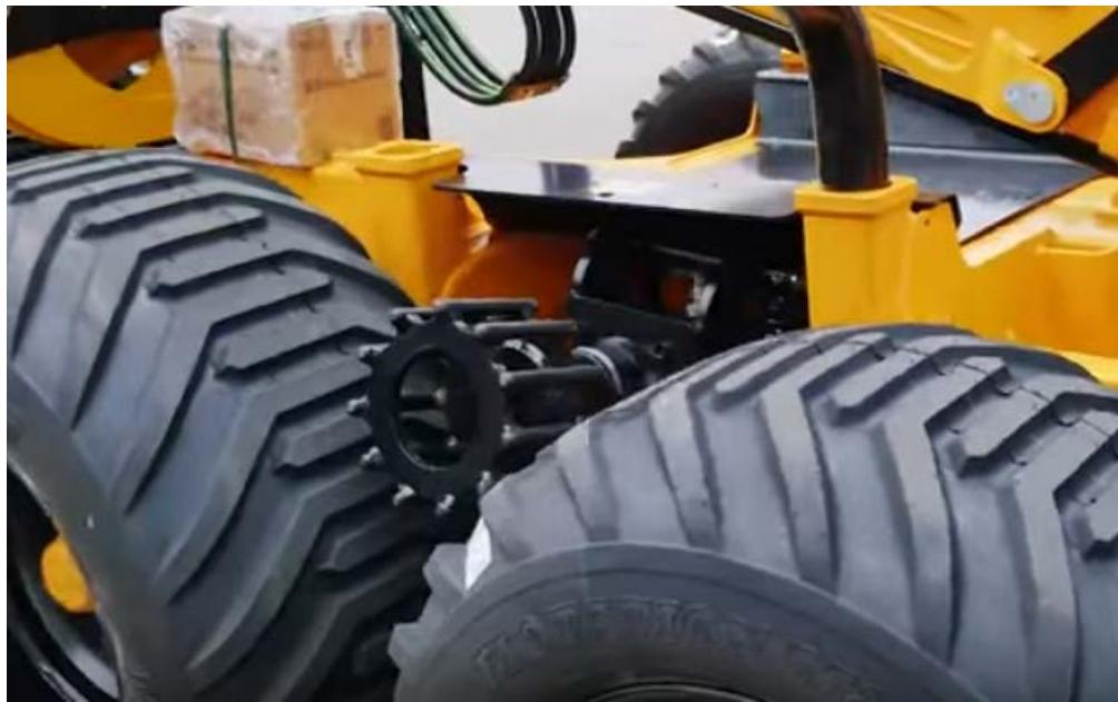
Slika 12. Pogon kotača oblikom preko pneumatika
