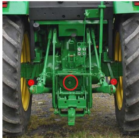
**Slika 46. PTO izlaz na traktoru [34]**
