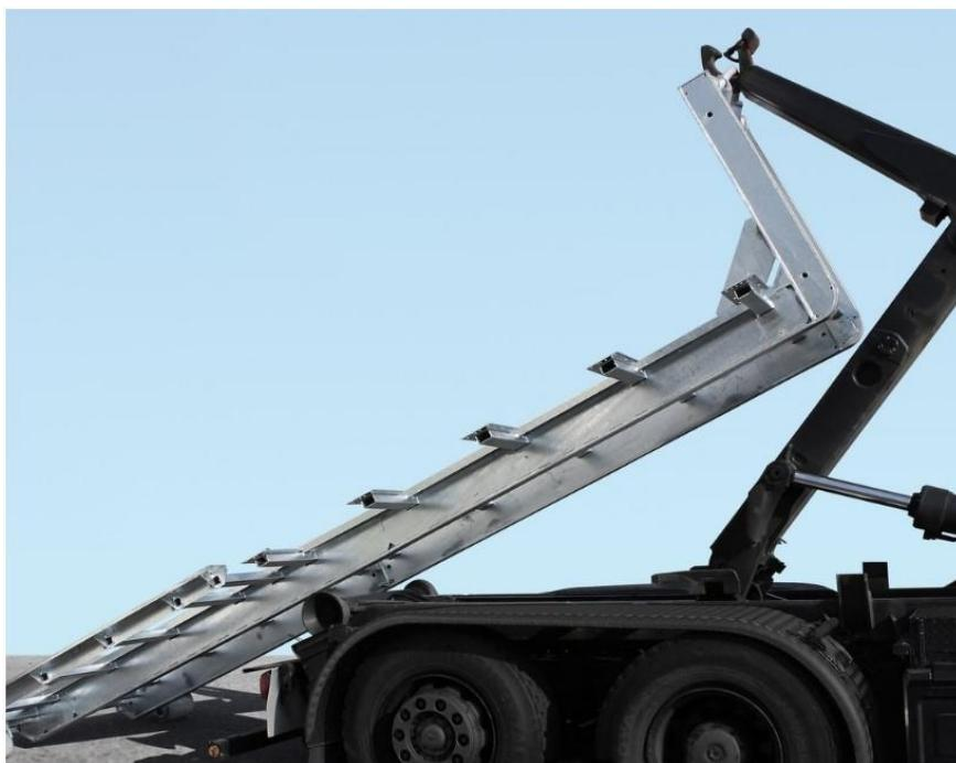
Slika 3.45. Podizanje kontejnera pomoću navlakača [22]
