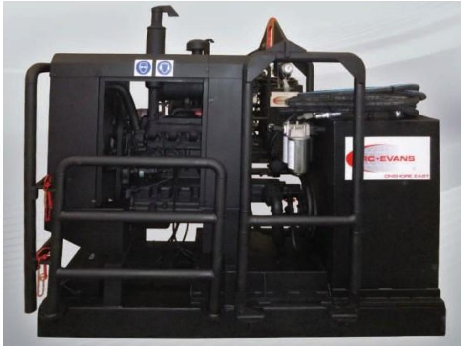
Slika 2.3. Stacionarna pogonska jedinica u obliku hidroagregata [3]
