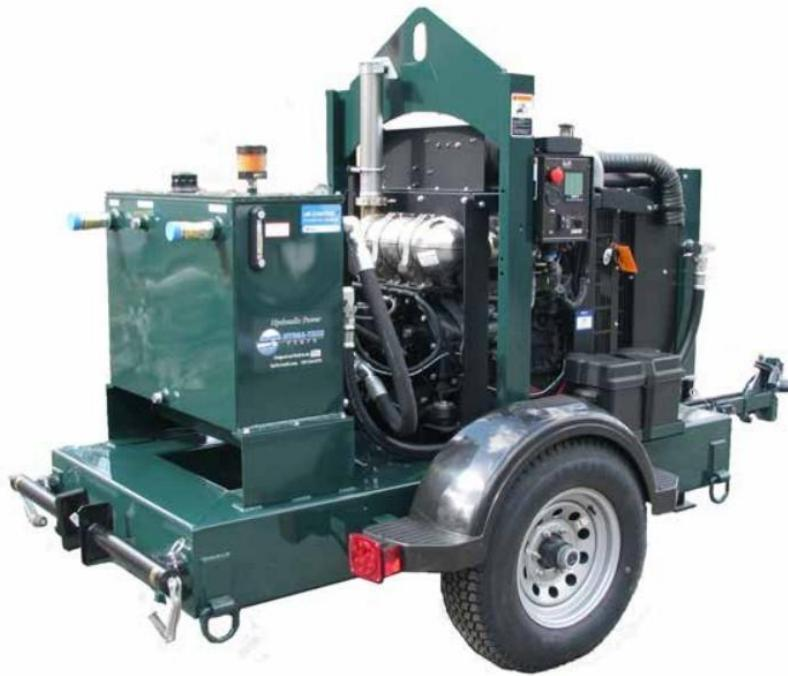
Slika 2.4. Mobilna pogonska jedinica u obliku hidroagregata [4]
