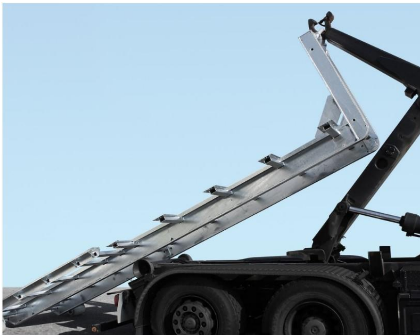
Slika 3.45. Podizanje kontejnera pomoću navlakača [22]
