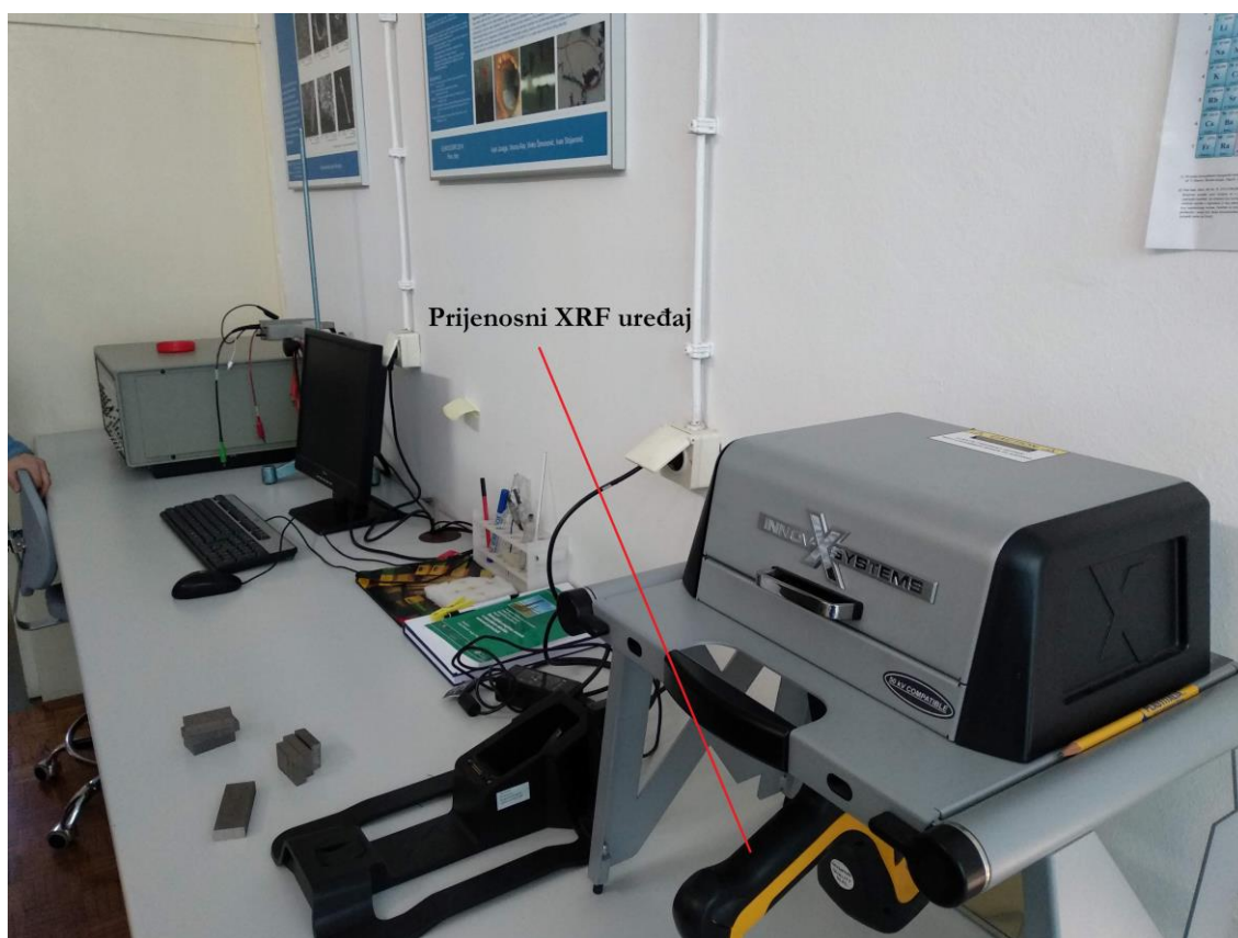
Slika 23: Sustav za XRF analizu kemijskog sastava materijala
