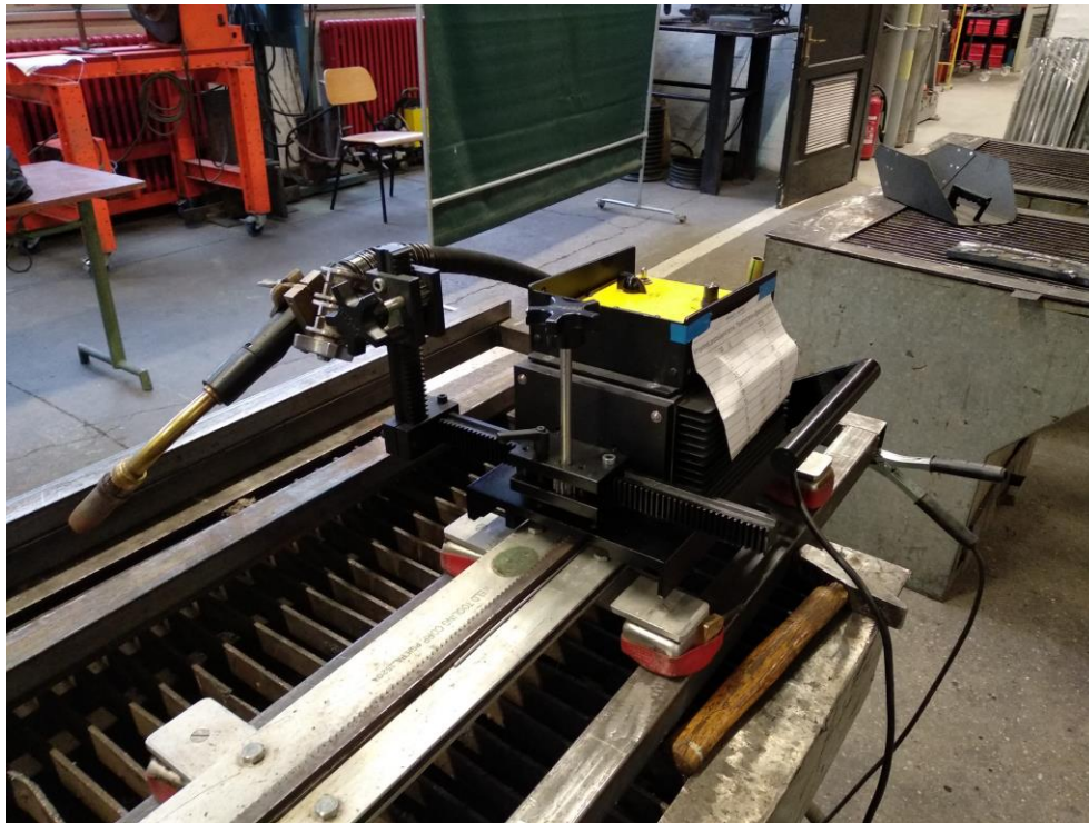
Slika 25: „BUGO Systems“ sustav za mehanizaciju postupka zavarivanja
