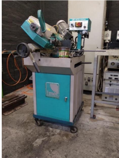
Slika 30: Tračna pila IMET GBS 185 Eco AutoCut
