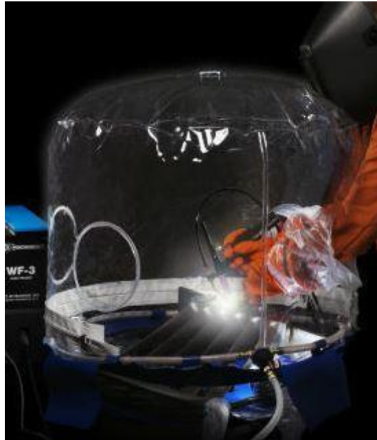
Slika 22: Izvođenje postupka zavarivanja u komori za zavarivanje [29]
