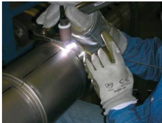
Slika 5: Primjena TIG postupka za zavarivanje cijevi izrađene od titanija [8]
