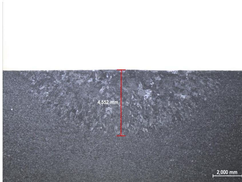
Slika 32: Profil navara i izmjerena dubina penetracije na uzorku A2
