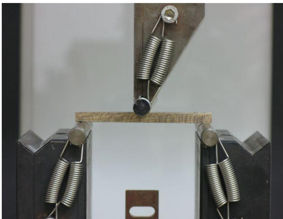
Slika 28. Ispitni uzorak na kidalici neposredno prije opterećivanja
