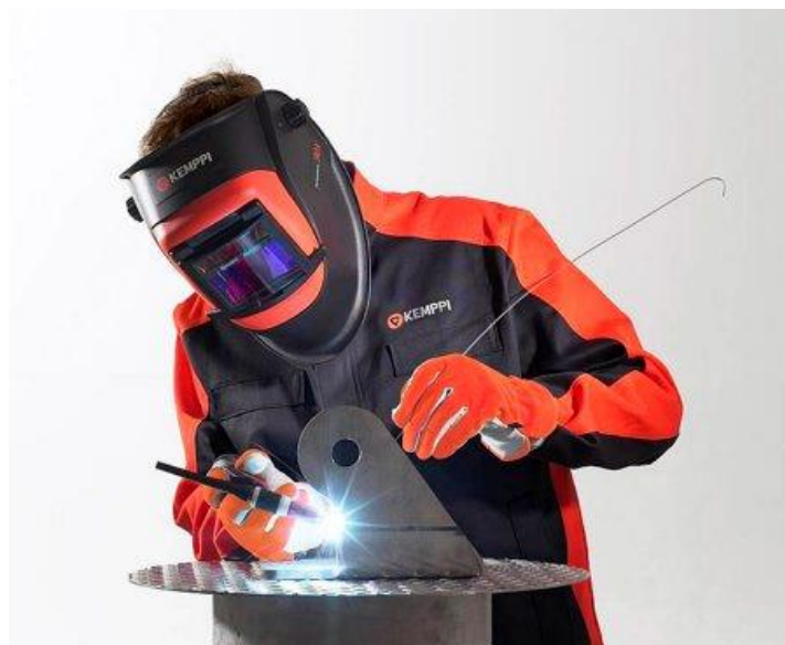
Slika 12. Ručno TIG zavarivanje [13]
