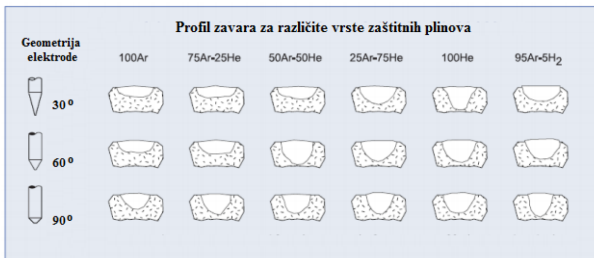
Slika 37. Utjecaj vrste plina i mješavine plinova na oblik zavara i penetraciju [26]
