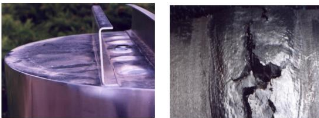
Slika 9. Prikaz karakterističnih problema kod zavarivanja austenitnih nehrđajućih čelika [9]
