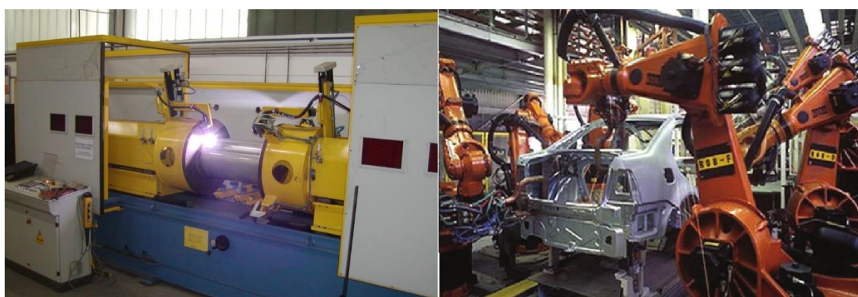
Slika 25. Primjer robotiziranog (desno) i automatiziranog (lijevo) zavarivanja [37]
