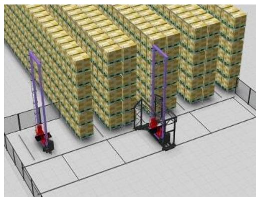
Slika 3. *Aisle-to-aisle* dizalica [9]
