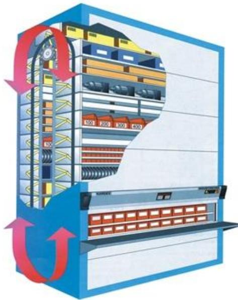
Slika 9. Vertikalni karusel [14]
